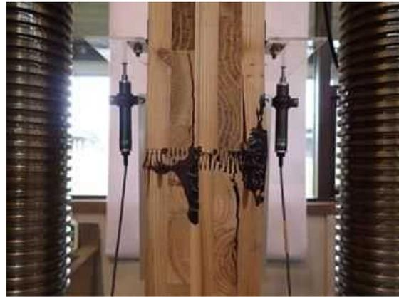
図IV. 2 9-(b) CNK150-05 破壊性状
