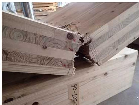
図VI. 2-(b) プライ縦継ぎ部の破断 (PBNC-02)
