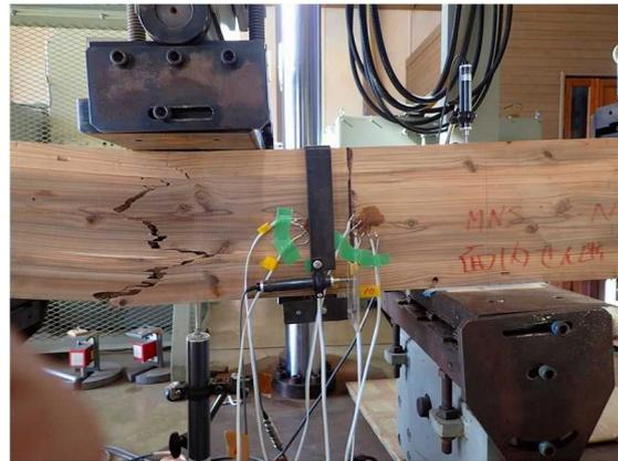
図III-29-(b)MNS-KN150-05 破壊性状
