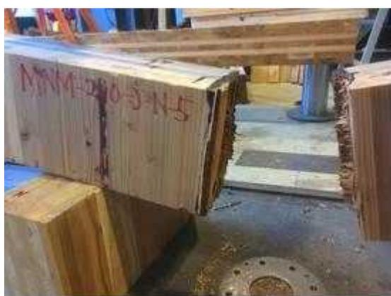
図 II. 5 9-(b) MNM-NJ210-05 破壊性状
