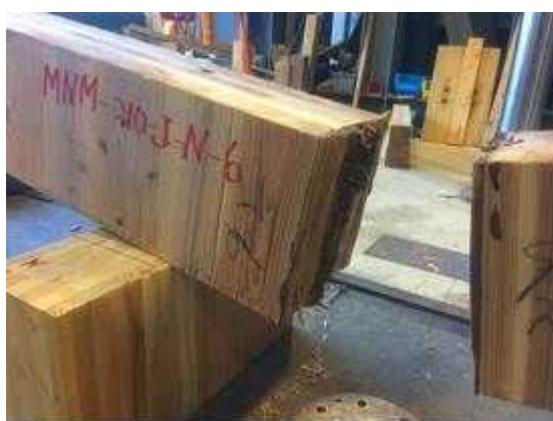
図 II. 6 0-(b) MNM-NJ210-06 破壊性状
