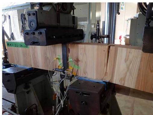
図III-46-(b)MNS-JL150-04 破壊性状
