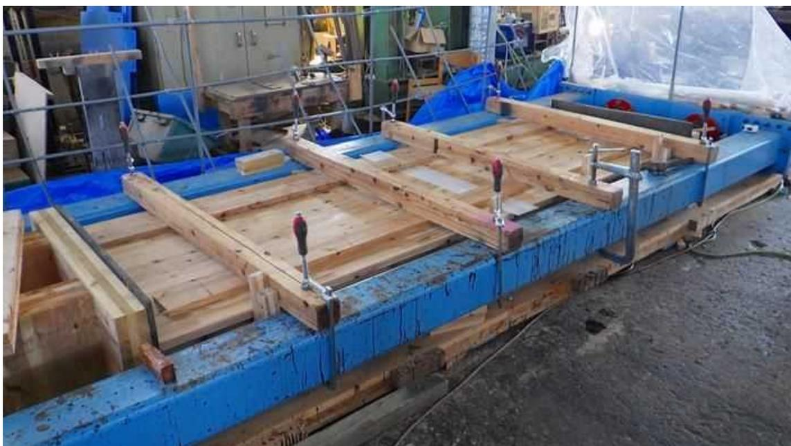
図2. 5. 3 試作嵌合機による試験体の嵌合状況
