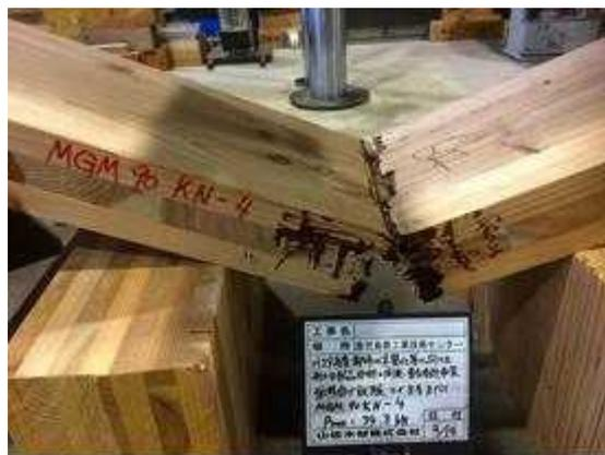
図 I. 4-(b) MGM-NK90-04 破壊性状
