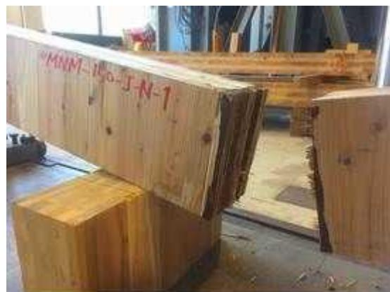
図 II. 3 1-(b) MNM-NJ150-01 破壊性状
