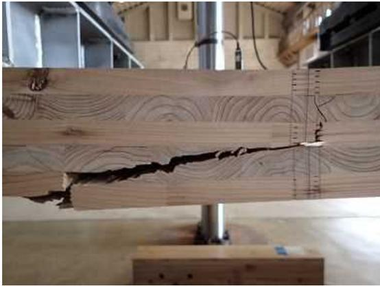
図VI. 4-(c)他方の側面におけるラミナ縦継ぎフィンガーからの破壊 (PBNC-03)
