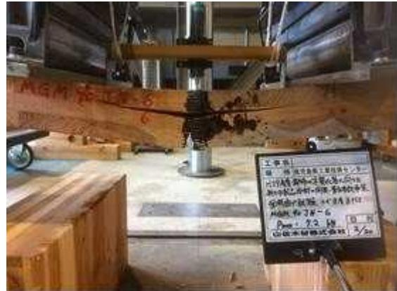
図 I. 1 2-(b) MGM-NJ90-06 破壊性状
