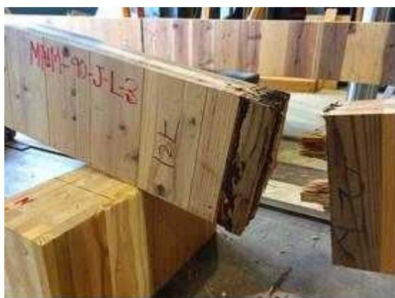
図 II. 21-(b) MNM-LJ90-03 破壊性状
