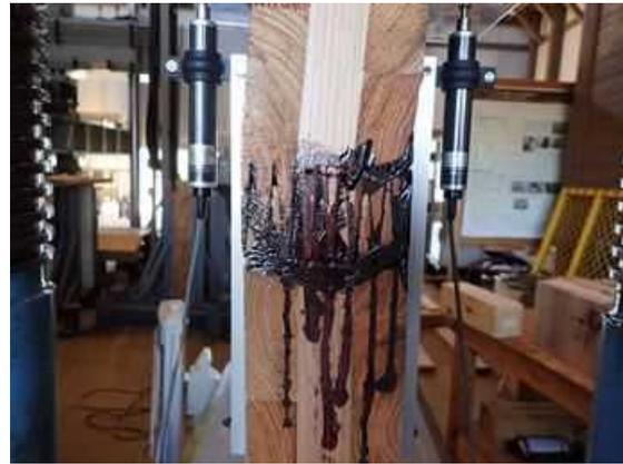
図IV. 20-(b) CLJ90-02 破壊性状
