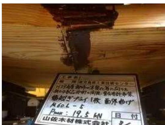
図V. 17-(b) M60L-05 破壊性状
