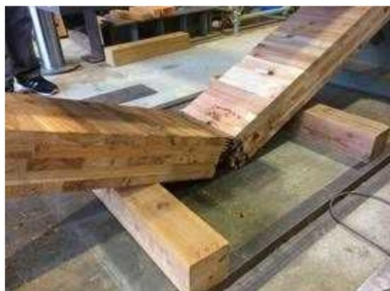
図 I. 4 7-(b) MGM-LJ150-05 破壊性状
