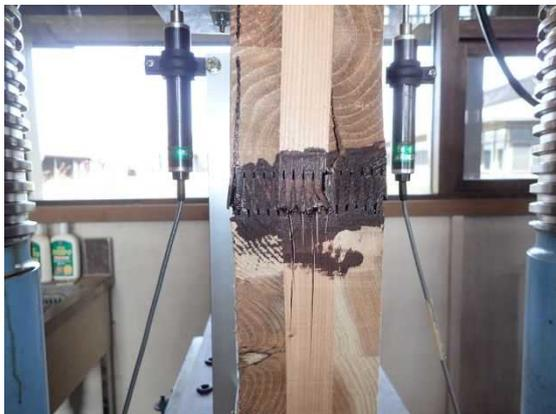
図 5. 5. 14 ノーマルフィンガー頂部から CLT 割裂破壊 (CNJ90)
