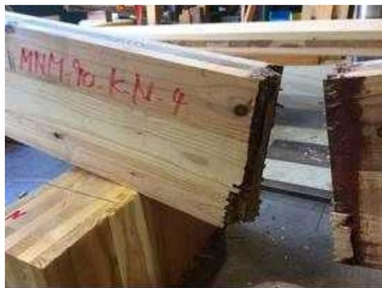
図 II. 4-(b) MNM-NK90-04 破壊性状
