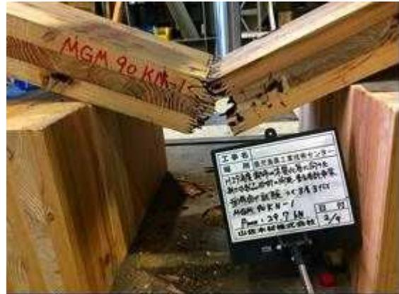
図 I. 1-(b) MGM-NK90-01 破壊性状
