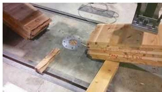
図 I. 59-(b) MGM-NJ210-05 破壊性状
