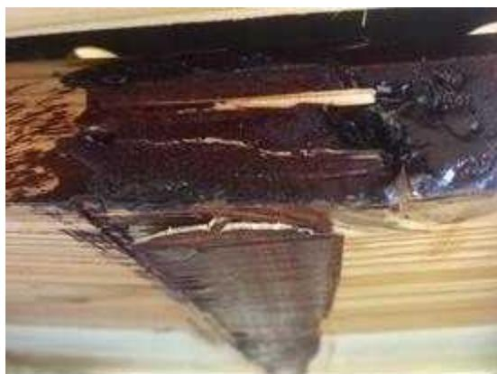
図V. 16-(b) M60L-04 破壊性状
