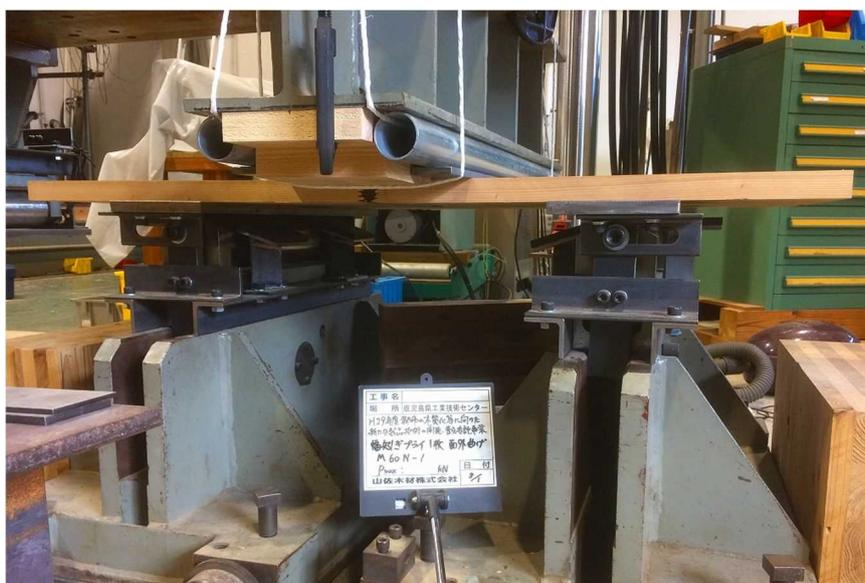
図6. 2. 2-(b) 幅矧ぎプライの面外曲げ試験の状況 (鉄パイプ部分が加力点) (鹿児島県工業試験センター)
