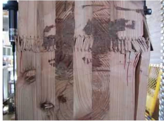
図IV. 5 2-(b) CNK210-04 破壊性状
