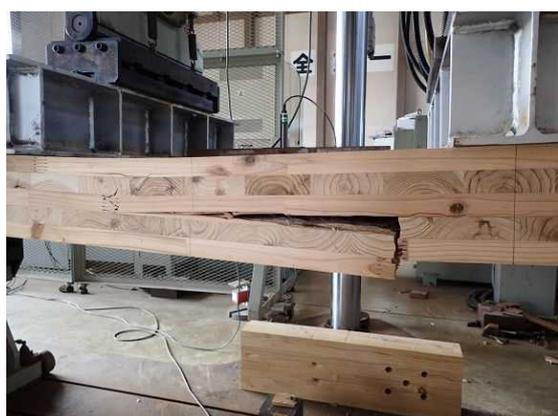
図6. 3. 9 破壊性状全体 (PBNR-03)
