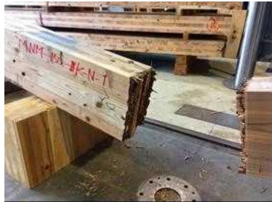
図 II. 25-(b) MNM-NK150-01 破壊性状
