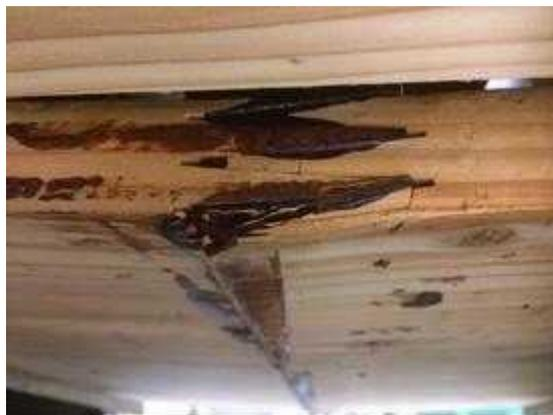
図 V. 4-(b) M30L-04 破壊性状
