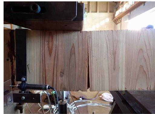
図III-44-(b)MNS-JL150-02 破壊性状
