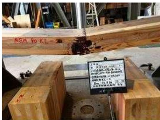
図 I. 1 4 -(b) MGM-LK90-02 破壊性状
