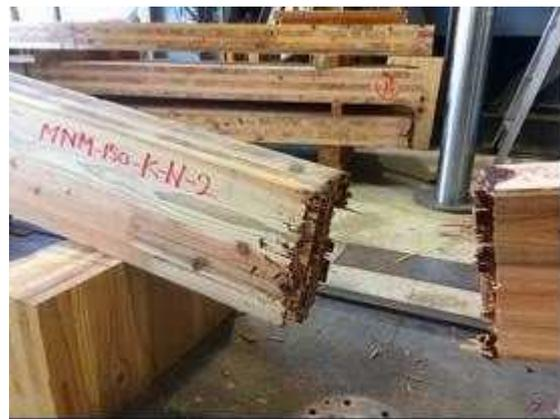
図 II. 26-(b) MNM-NK150-02 破壊性状
