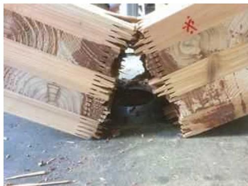
図 I. 28-(b) MGM-NK150-04 破壊性状
