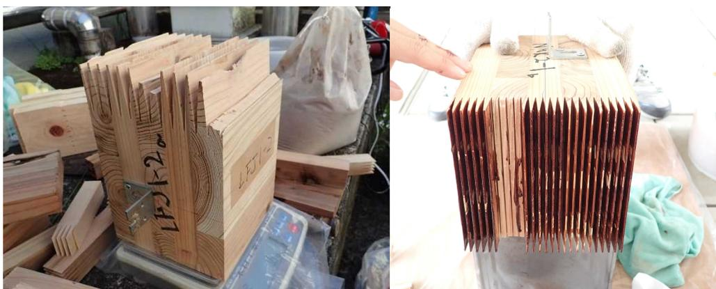
a) LF 弱軸試験体
