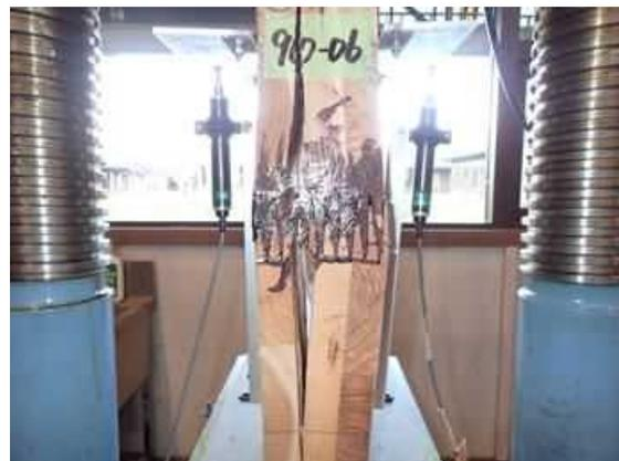
図IV. 2 4-(b) CLJ90-06 破壊性状
