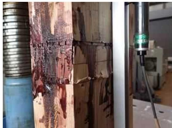
図IV. 1 5-(b) CLK90-03 破壊性状
