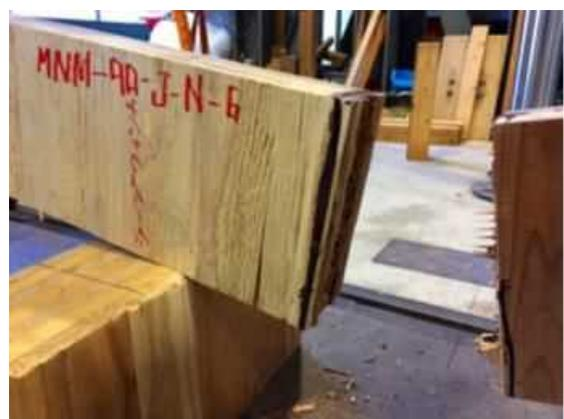
図 II. 12-(b) MNM-NJ90-06 破壊性状
