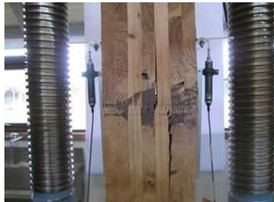
図IV. 5 6 -(b) CNJ210-02 破壊性状
