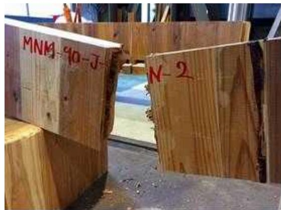
図 II. 8-(b) MNM-NJ90-02 破壊性状
