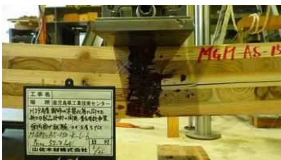
図 I. 7 2-(b) MGM-LK150AS-06 破壊性状
