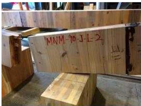
図 II. 20-(b) MNM-LJ90-02 破壊性状
