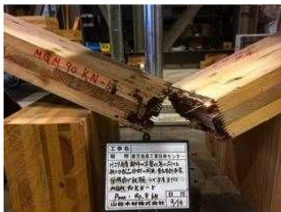
図 I. 5-(b) MGM-NK90-05 破壊性状
