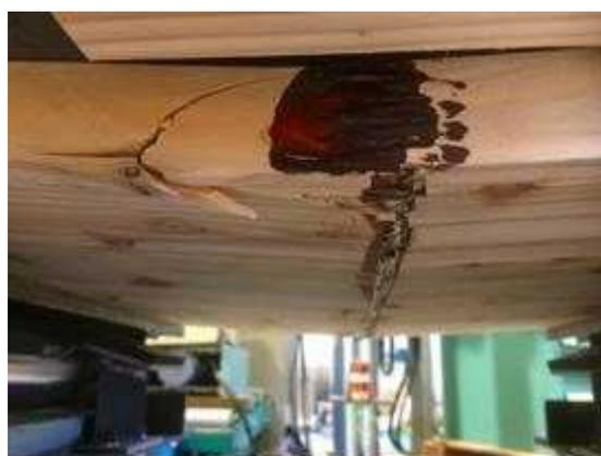
図 V. 8-(b) M30N-02 破壊性状
