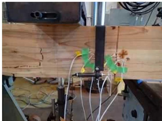
図III-37-(b)MNS-KL150-01 破壊性状
