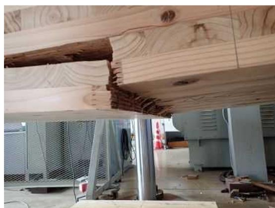
図VI. 7-(b) 最外層プライ縦継ぎフィンガ一部での引張破壊 (PBNR-03)
