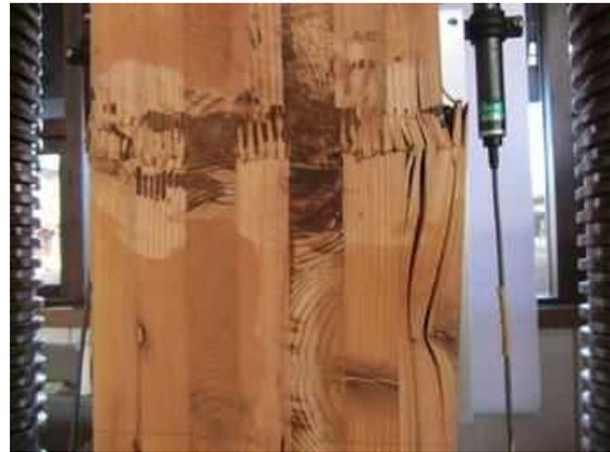
図IV. 50-(b) CNK210-02 破壊性状
