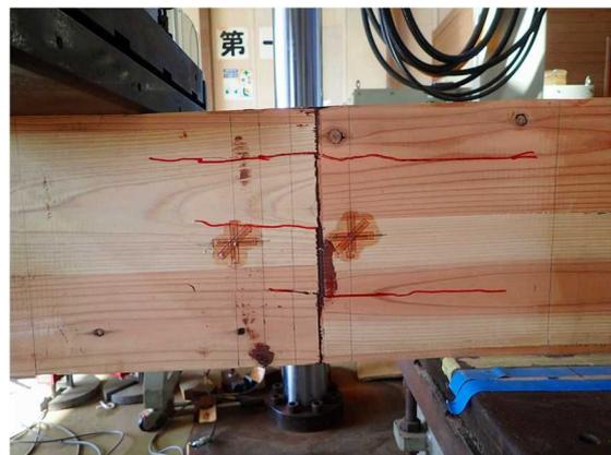
図III-18-(b)MNS-KL90-06 破壊性状
