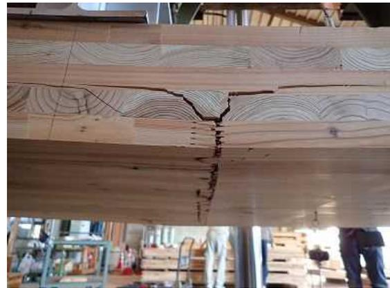
図VI. 5-(b) 片側面最外層プライ縦継ぎフィンガーの引張破壊 (PBNR-01)
