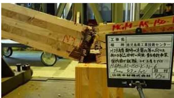
図 I. 6 6-(b) MGM-NK150AS-06 破壊性状
