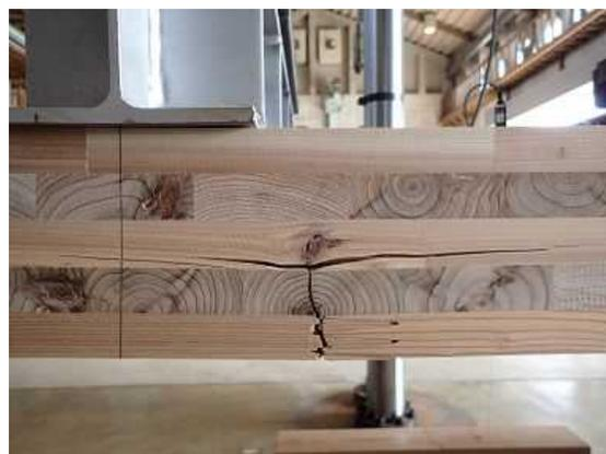
図VI. 1 2-(b) 最外層プライ縦継ぎフィンガー部での引張破壊 (PBLR-02)
