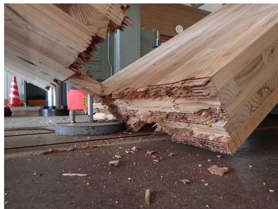
図6. 3. 8 フィンガー根元部の引張破壊及び一部ラミナ縦継ぎ部での破断 (PBNC-01)
