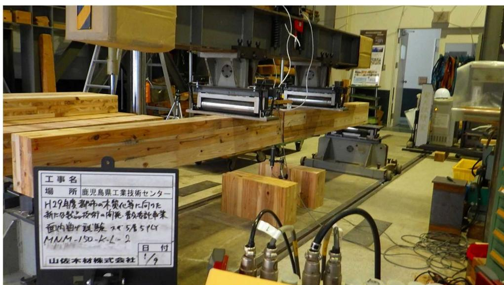
図 3. 3. 1-(b) CLT パネル面内曲げ試験 (鹿児島県工業試験場)
