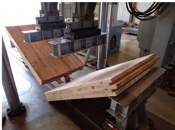
図6. 3. 7 破壊性状全体 (PBNC-01)
