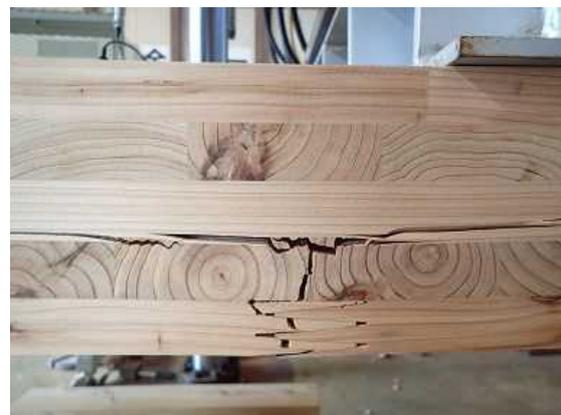
図VI. 11 -(b) 最外層プライ縦継ぎフィンガー部での引張破壊 (PBLR-01)
