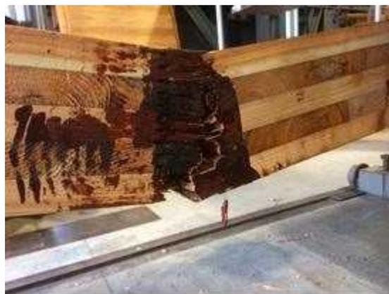
図 I. 3 7-(b) MGM-LK150-01 破壊性状
