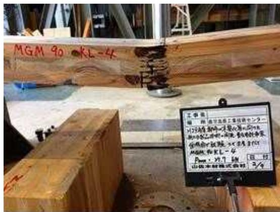
図 I. 16-(b) MGM-LK90-04 破壊性状
