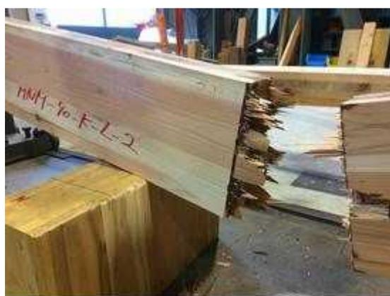
図 II. 14-(b) MNM-LK90-02 破壊性状
