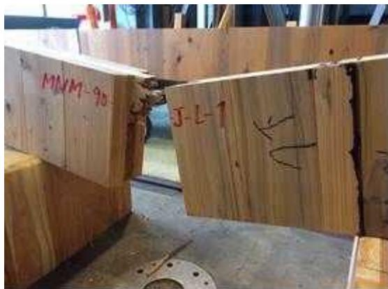
図 II. 19-(b) MNM-LJ90-01 破壊性状
