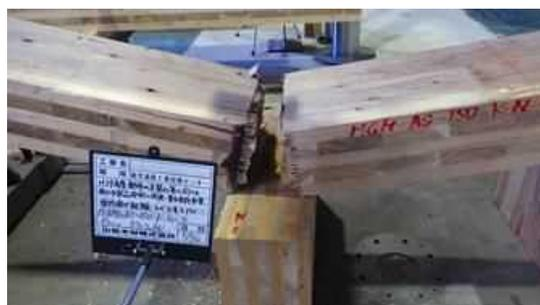
図 I. 6 3-(b) MGM-NK150AS-03 破壊性状
