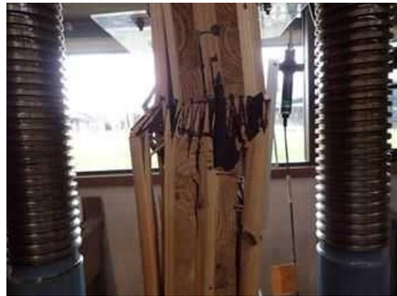
図IV. 4 1-(b) CLK150-05 破壊性状
