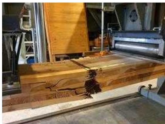
図 I. 4 1-(b) MGM-LK150-05 破壊性状
