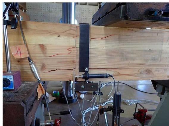
図III-30-(b)MNS-KN150-06 破壊性状
