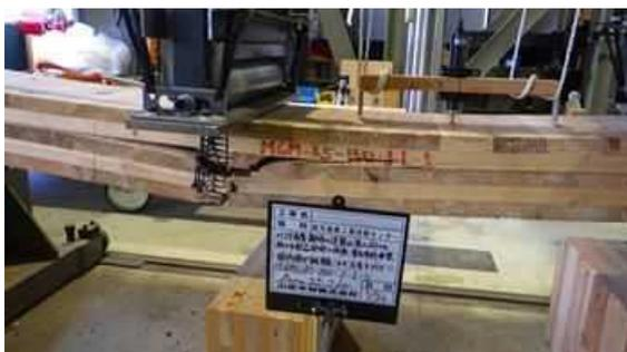
図 I. 77-(b) MGM-LJ150AS-05 破壊性状
