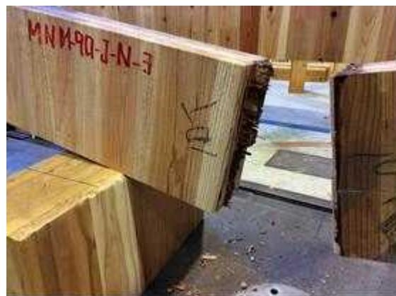
図 II. 9-(b) MNM-NJ90-03 破壊性状
