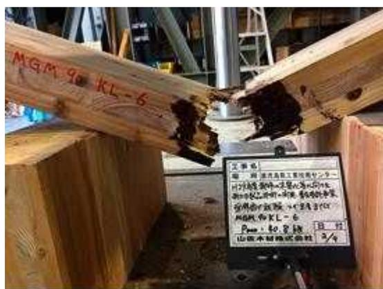
図 I. 18-(b) MGM-LK90-06 破壊性状
