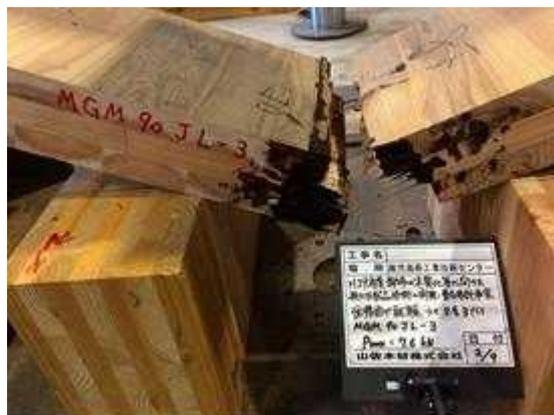
図 I. 21-(b) MGM-LJ90-03 破壊性状
