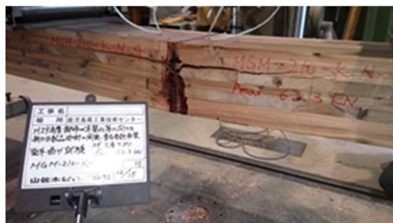
図 I. 5 2-(b) MGM-NK210-04 破壊性状
