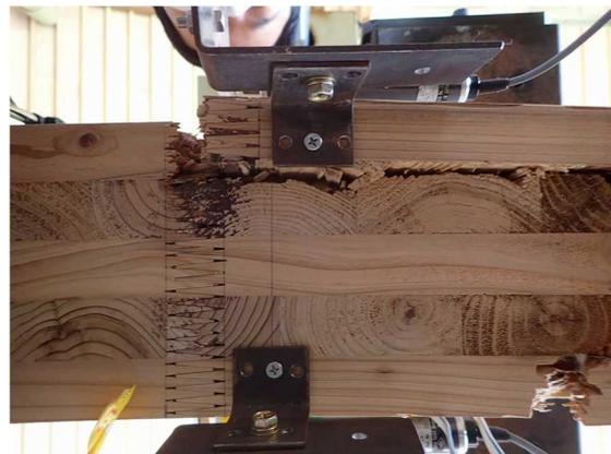
図III-26-(b)MNS-KN150-02 破壊性状
