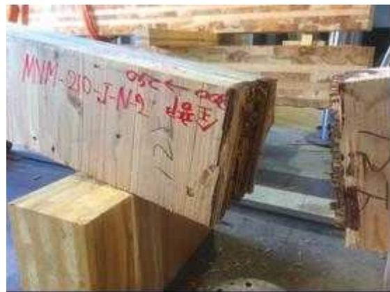
図 II. 5 6-(b) MNM-NJ210-02 破壊性状
