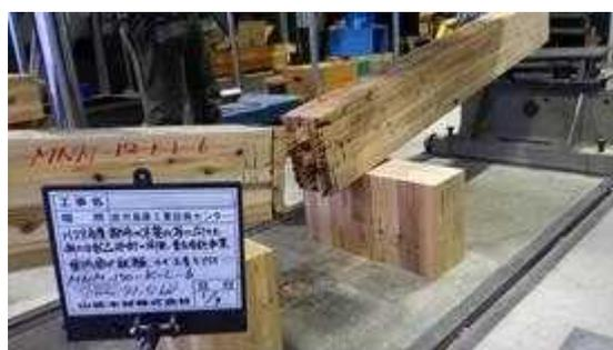
図 II. 42-(b) MNM-LK150-06 破壊性状
