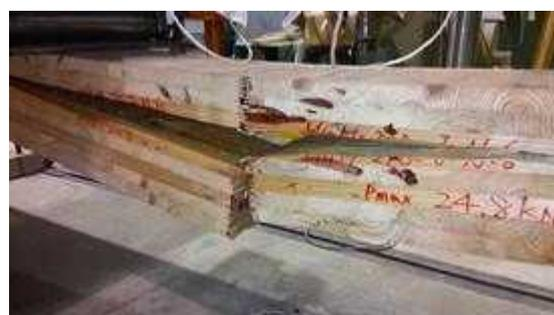
図 I. 60-(b) MGM-NJ210-06 破壊性状
