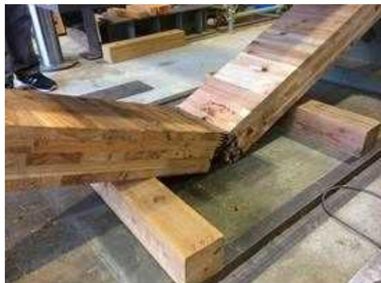
図 I. 4 6-(b) MGM-LJ150-04 破壊性状
