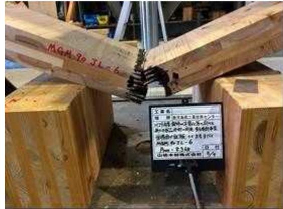
図 I. 2 4-(b) MGM-LJ90-06 破壊性状
