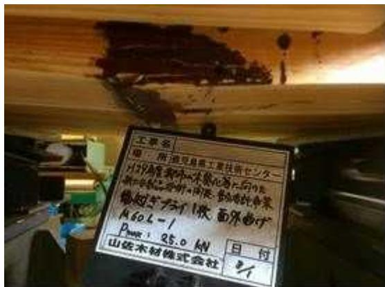
図V. 13-(b) M60L-01 破壊性状
