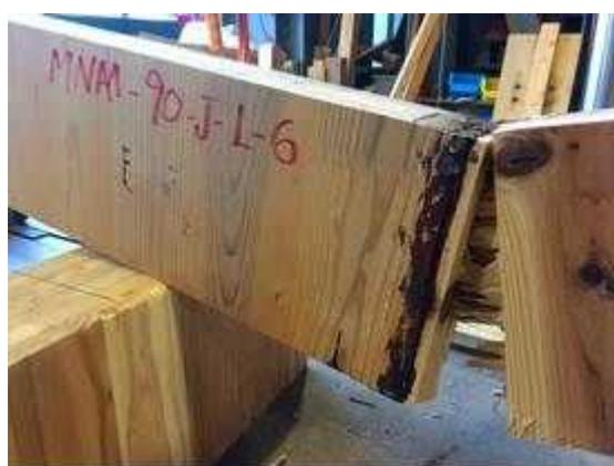
図 II. 2 4-(b) MNM-LJ90-06 破壊性状
