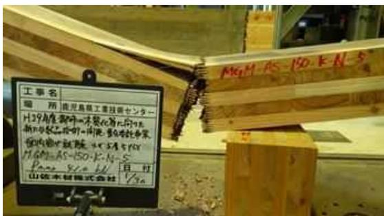
図 I. 6 5-(b) MGM-NK150AS-05 破壊性状
