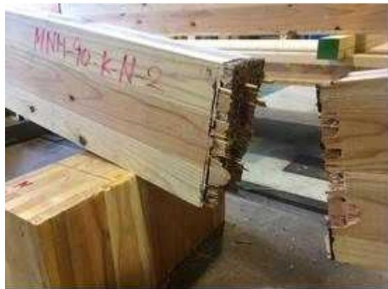
図 II. 2-(b) MNM-NK90-02 破壊性状
