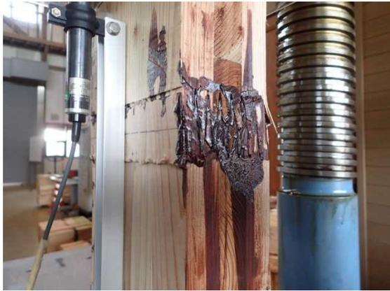
図 5. 5. 12 ラージフィンガー端部における圧縮破壊 (CLK90)
