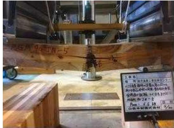
図 I. 1 1-(b) MGM-NJ90-05 破壊性状
