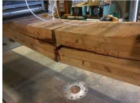
図 I. 55-(b) MGM-NJ210-01 破壊性状
