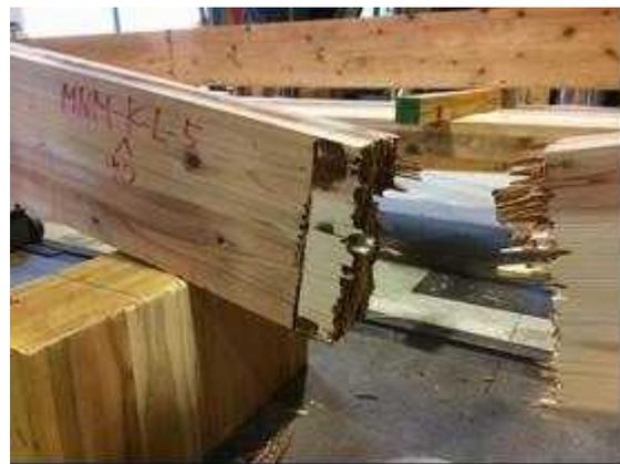
図 II. 1 7 -(b) MNM-LK90-05 破壊性状
