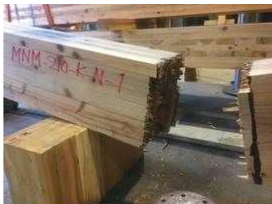
図 II. 49-(b) MNM-NK210-01 破壊性状
