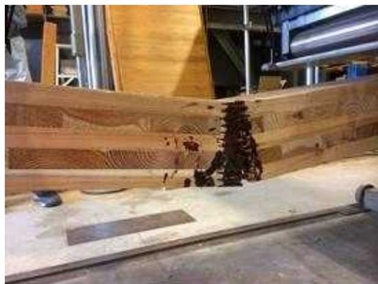
図 I. 3 9-(b) MGM-LK150-03 破壊性状
