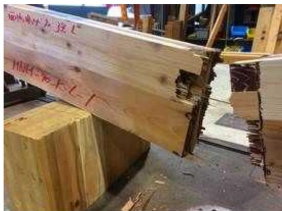
図 II. 13-(b) MNM-LK90-01 破壊性状
