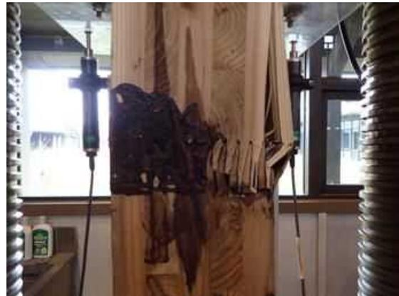
図IV. 3 9-(b) CLK150-03 破壊性状
