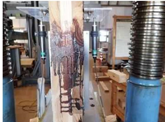
図IV. 21-(b) CLJ90-03 破壊性状
