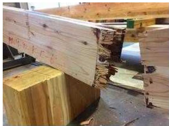
図 II. 1 8 -(b) MNM-LK90-06 破壊性状
