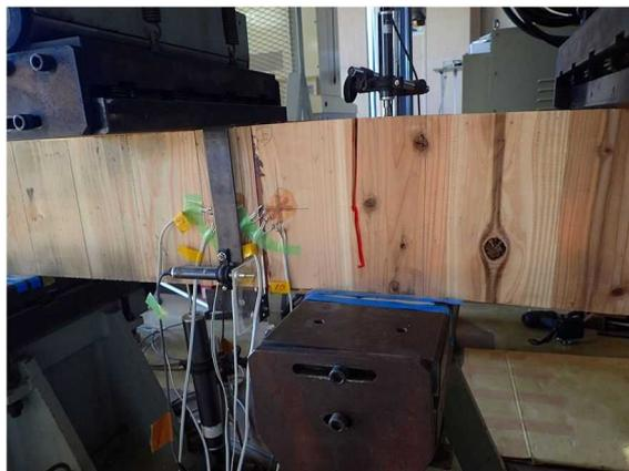
図III-34-(b)MNS-JN150-04 破壊性状
