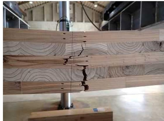
図VI. 10 -(b) プライ縦継ぎフィンガー部の引張破壊 (PBLC-03)
