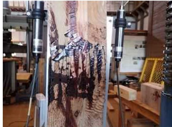
図IV. 2 2-(b) CLJ90-04 破壊性状
