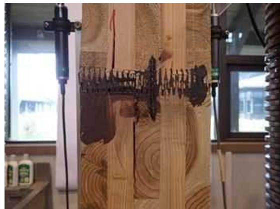
図IV. 3 3-(b) CNJ150-03 破壊性状
