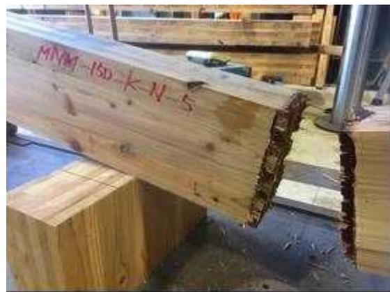
図 II. 29-(b) MNM-NK150-05 破壊性状
