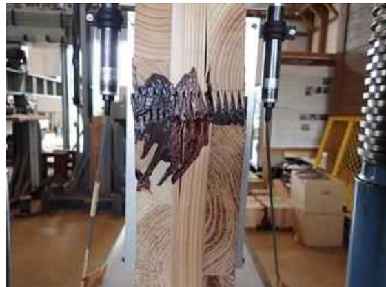
図IV. 11-(b) CNJ90-05 破壊性状
