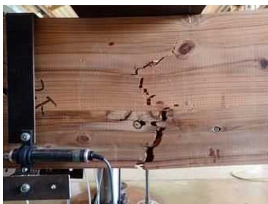
図III-15-(b)MNS-KL90-03 破壊性状
