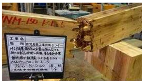
図 II. 41-(b) MNM-LK150-05 破壊性状
