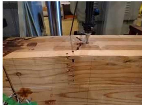
図III-42-(b)MNS-KL150-06 破壊性状
