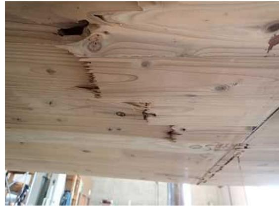
図VI. 4-(b) 試験体の底面におけるラミナ縦継ぎフィンガーの引張破壊 (PBNC-03)
