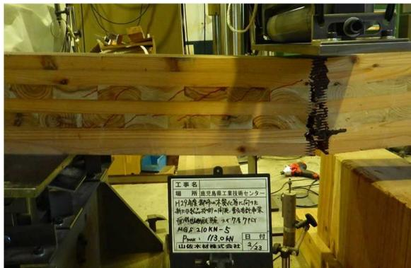
図 4. 4. 13 ローリングシアー破壊の例
