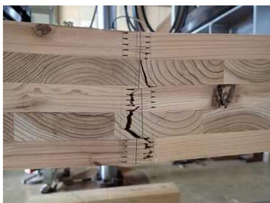
図VI. 3-(b) 片側面におけるプライ縦継ぎフィンガーからの破壊 (PBNC-03)
