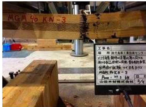
図 I. 3-(b) MGM-NK90-03 破壊性状
