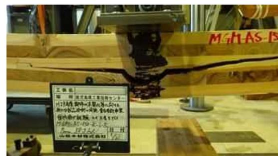
図 I. 7 1-(b) MGM-LK150AS-05 破壊性状
