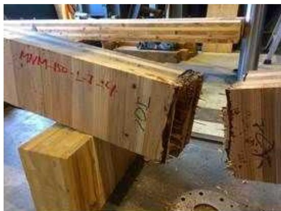
図 II. 4 6-(b) MNM-LJ150-04 破壊性状
