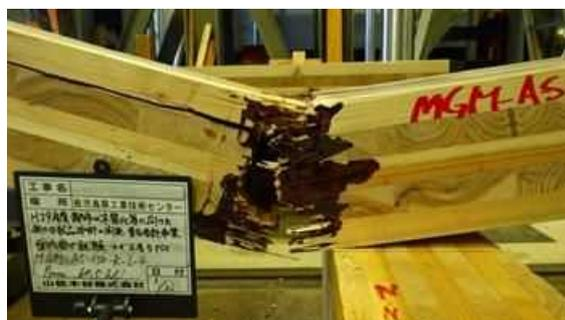
図 I. 7 0-(b) MGM-LK150AS-04 破壊性状
