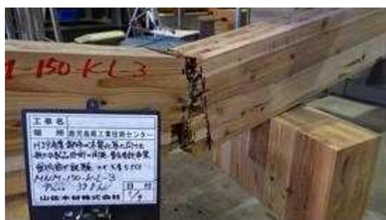
図 II. 39-(b) MNM-LK150-03 破壊性状
