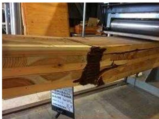
図 I. 3 8-(b) MGM-LK150-02 破壊性状
