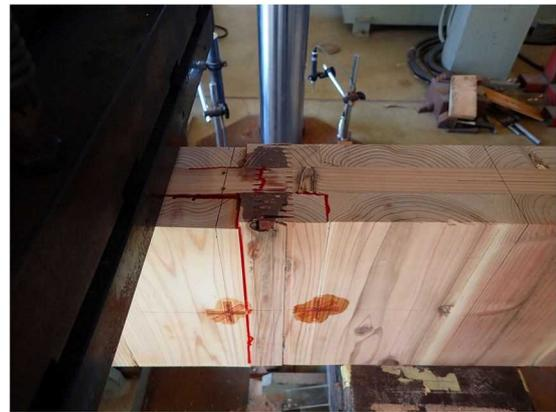
図III-11-(b)MNS-JN90-05 破壊性状
