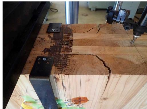
図III-60-(b)MNS-JN210-06 破壊性状
