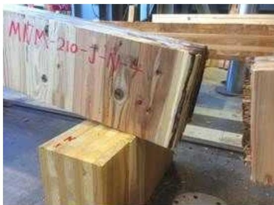
図 II. 5 8-(b) MNM-NJ210-04 破壊性状
