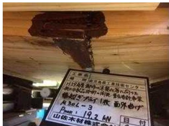
図 V. 3-(b) M30L-03 破壊性状
