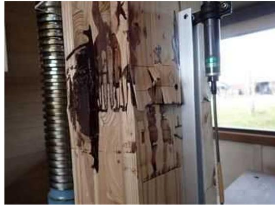
図IV. 3 7-(b) CLK150-01 破壊性状
