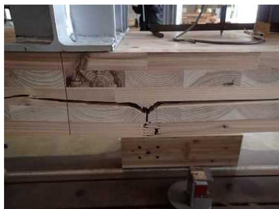
図VI. 6-(b) 最外層プライ縦継ぎフィンガ一部での引張破壊 (PBNR-02)
