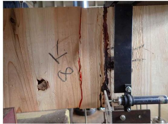
図III-22-(b)MNS-JL90-04 破壊性状
