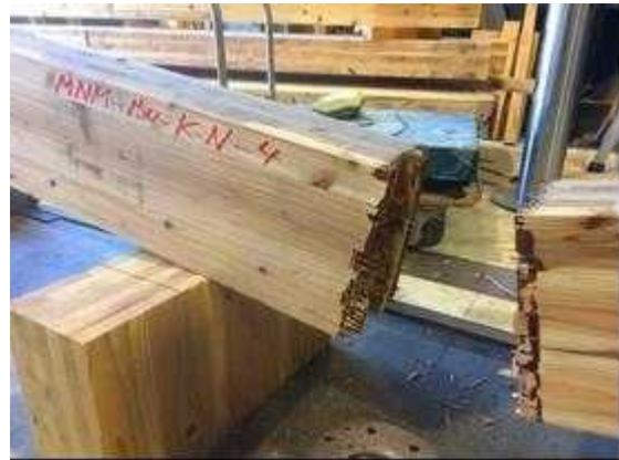
図 II. 28-(b) MNM-NK150-04 破壊性状
