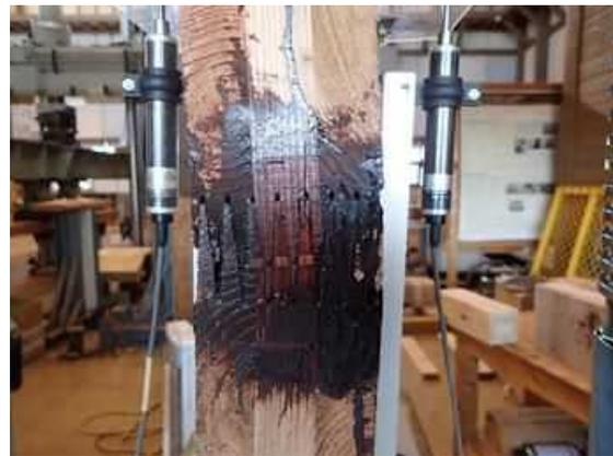
図IV. 2 3-(b) CLJ90-05 破壊性状
