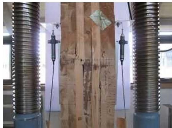
図IV. 5 7-(b) CNJ210-03 破壊性状
