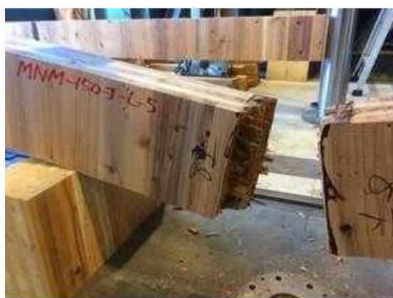
図 II. 4 7-(b) MNM-LJ150-05 破壊性状
