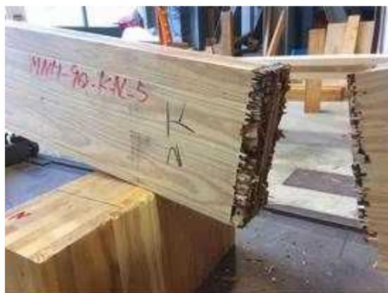
図 II. 5-(b) MNM-NK90-05 破壊性状
