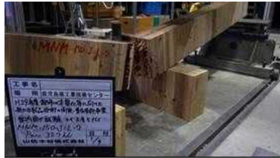
図 II. 4 4-(b) MNM-LJ150-02 破壊性状
