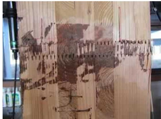
図IV. 51-(b) CNK210-03 破壊性状
