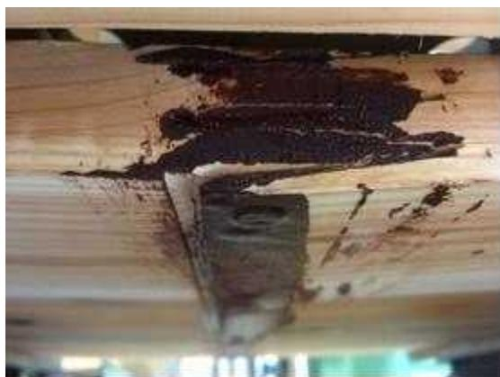
図V. 15-(b) M60L-03 破壊性状
