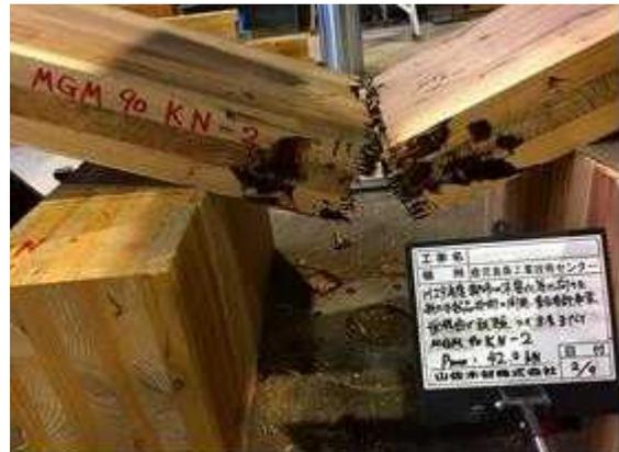
図 I. 2-(b) MGM-NK90-02 破壊性状
