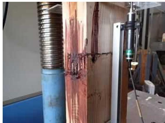
図IV. 1 8 -(b) CLK90-06 破壊性状
