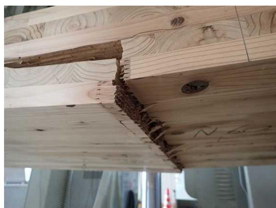
図6. 3. 10 最外層プライにおけるフィンガー部の引張破壊 (PBNR-03)
