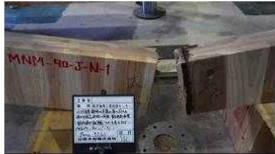
図 II. 7-(b) MNM-NJ90-01 破壊性状
