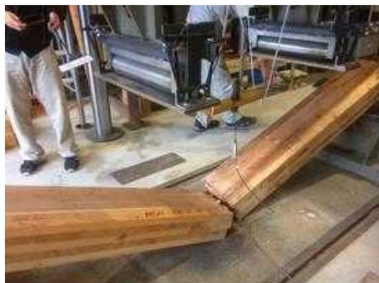
図 I. 2 5-(b) MGM-NK150-01 破壊性状
