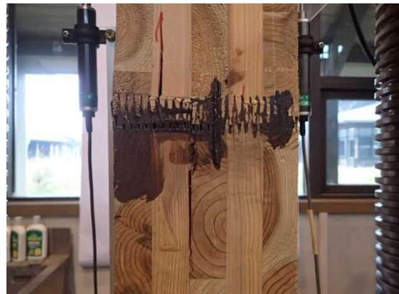
図 5. 5. 15 ノーマルフィンガー頂部からの CLT 割裂破壊 (CNJ150)
