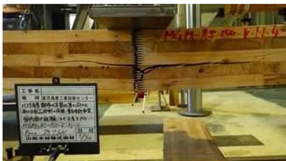
図 I. 6 4-(b) MGM-NK150AS-04 破壊性状
