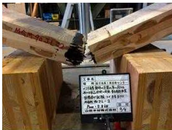
図 I. 20-(b) MGM-LJ90-02 破壊性状
