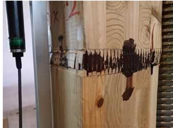
図IV. 2 5-(b) CNK150-01 破壊性状
