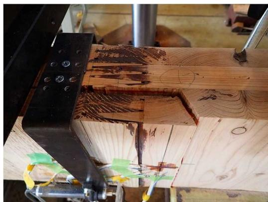
図Ⅲ-19-(b)MNS-JL90-01 破壊性状
