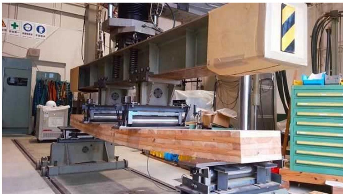
図 3. 2. 2-(b) FJ 接合した CLT パネルの面外曲げ試験 (FJ を中央に配した場合)
