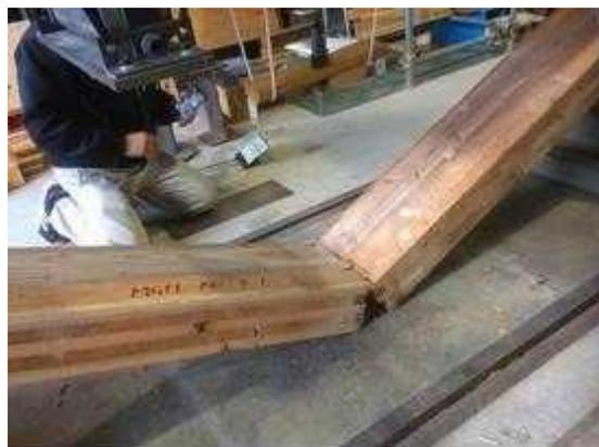
図 I. 2 7-(b) MGM-NK150-03 破壊性状
