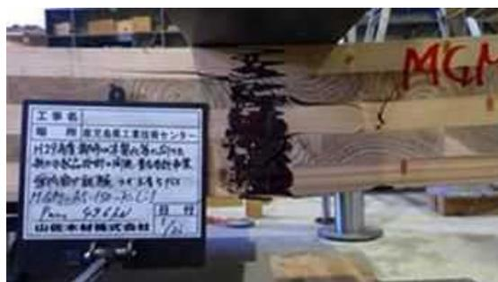
図 I. 6 7-(b) MGM-LK150AS-01 破壊性状
