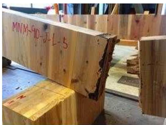
図 II. 2 3-(b) MNM-LJ90-05 破壊性状
