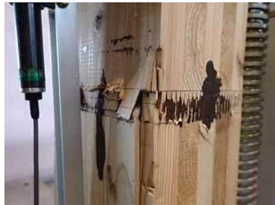
図IV. 2 6-(b) CNK150-02 破壊性状
