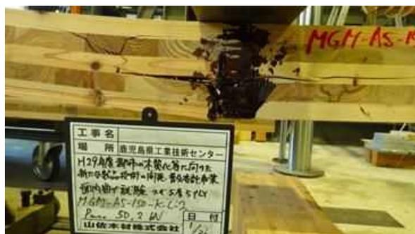
図 I. 6 8-(b) MGM-LK150AS-02 破壊性状
