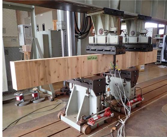
図 4. 3. 4 弱軸試験風景
