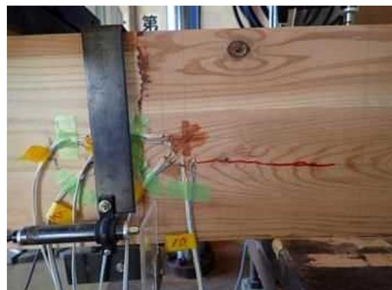
図III-6-(b)MNS-KN90-06 破壊性状
