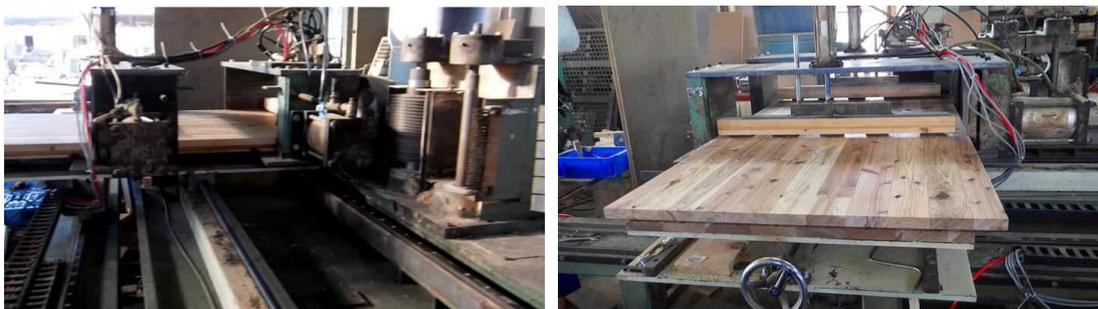
a) フィンガー切削部分を含む切削機の状況    b) 試験体側から見たフィンガー切削機械
