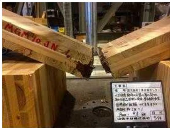
図 I. 7-(b) MGM-NJ90-01 破壊性状
