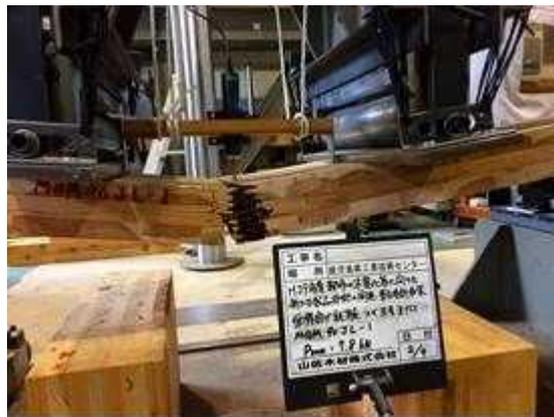
図 I. 19-(b) MGM-LJ90-01 破壊性状
