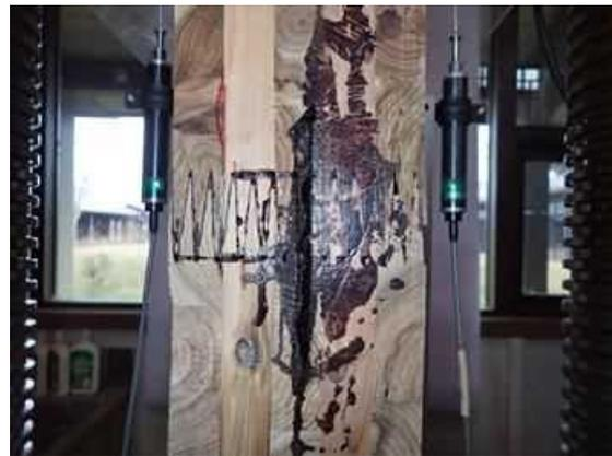
図IV. 4 7-(b) CLJ150-05 破壊性状
