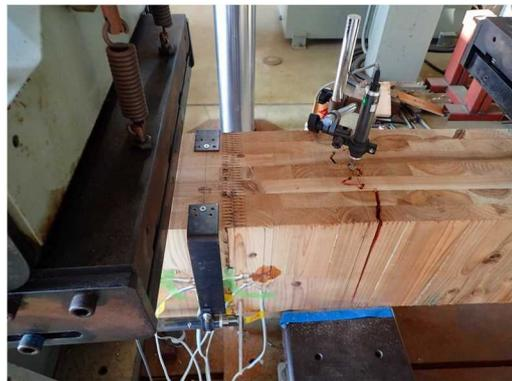
図III-57-(b)MNS-JN210-03 破壊性状
