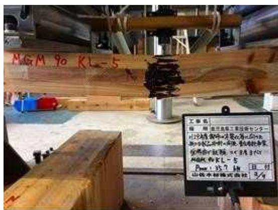
図 I. 17-(b) MGM-LK90-05 破壊性状
