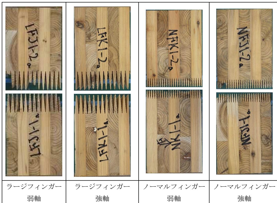
図2. 2. 2フィンガー加工した CLT の側面の様子
