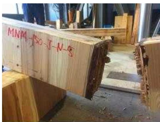
図 II. 3 5-(b) MNM-NJ150-05 破壊性状
