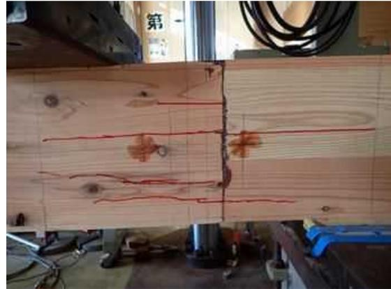
図III-16-(b)MNS-KL90-04 破壊性状
