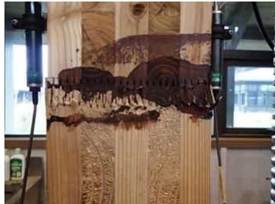
図IV. 3 0-(b) CNK150-06 破壊性状
