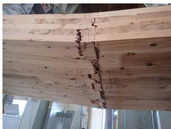
図VI. 8-(b) プライ縦継ぎフィンガー部の引張破壊 (PBLC-01)
