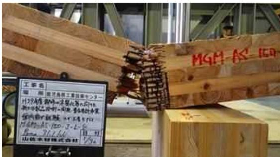
図 I. 76-(b) MGM-LJ150AS-04 破壊性状
