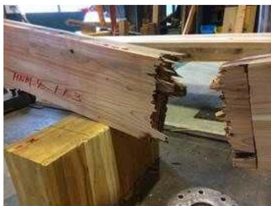
図 II. 15-(b) MNM-LK90-03 破壊性状
