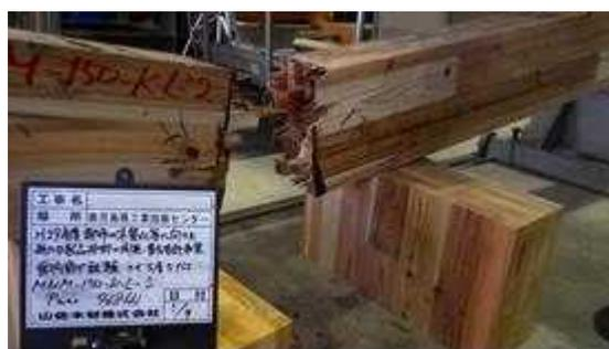
図 II. 38-(b) MNM-LK150-02 破壊性状
