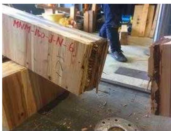
図 II. 3 6-(b) MNM-NJ150-06 破壊性状
