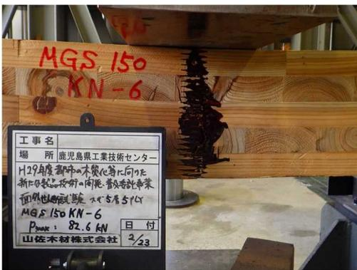
図 4. 4. 12 曲げ破壊の例
