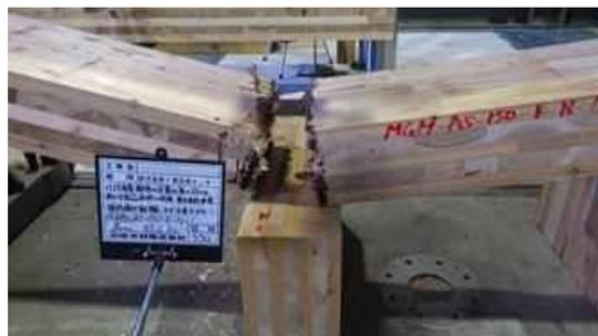
図 I. 6 1-(b) MGM-NK150AS-01 破壊性状
