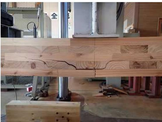
図VI. 5-(c) 片側面ラミナ縦継ぎフィンガーの引張破壊 (PBNR-01)
