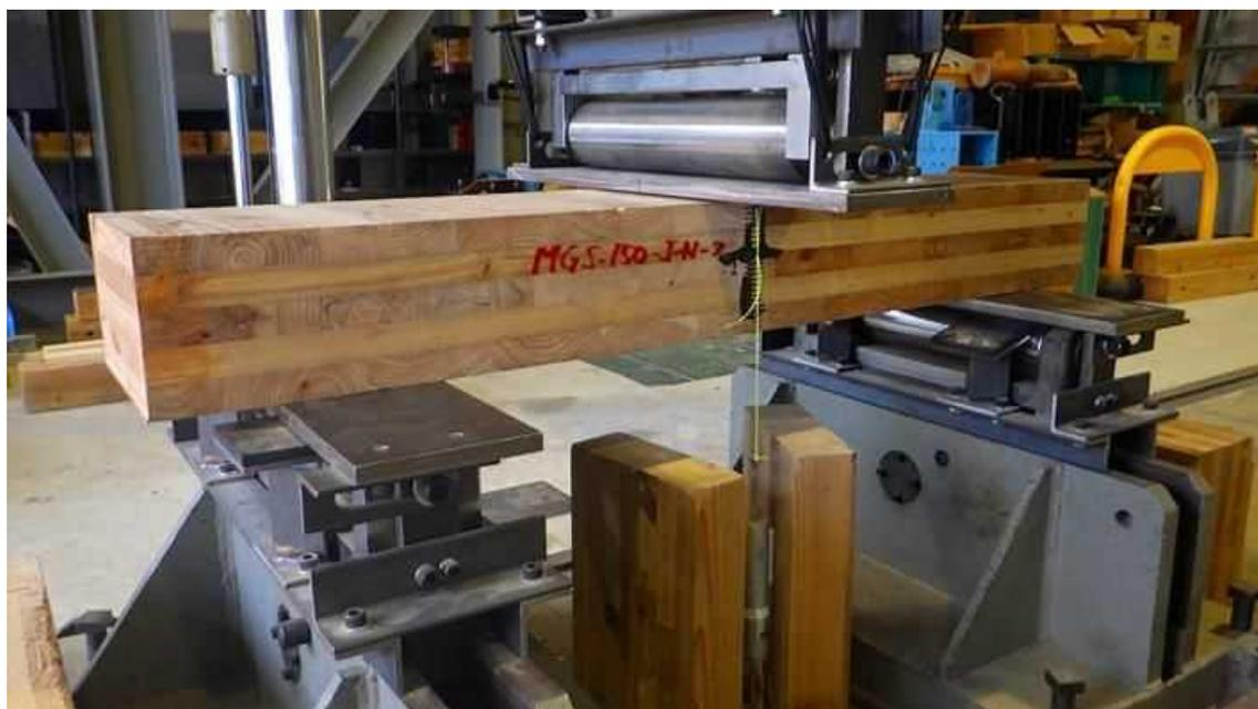
図4. 4. 1-(b) FJ 接合した CLT パネルの面外せん断試験法（鹿児島県工業試験場）
