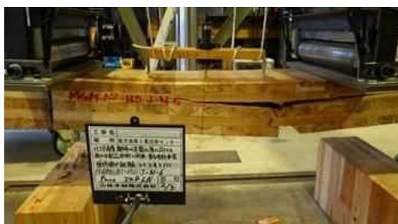
図 I. 8 4-(b) MGM-NJ150AS-06 破壊性状
