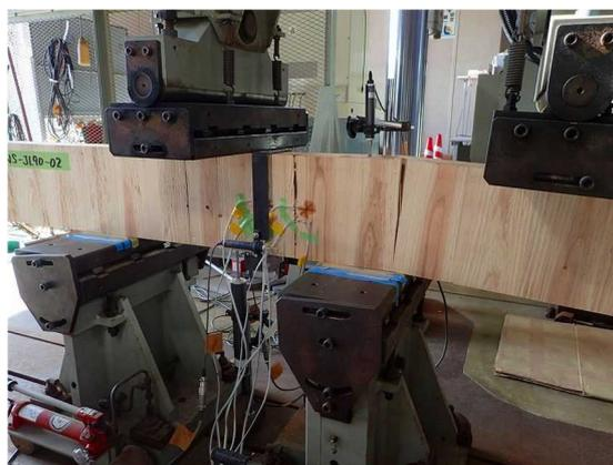
図Ⅲ-20-(b)MNS-JL90-02 破壊性状
