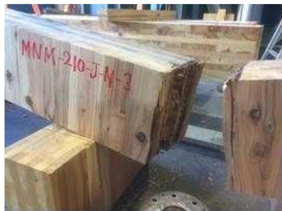
図 II. 5 7-(b) MNM-NJ210-03 破壊性状
