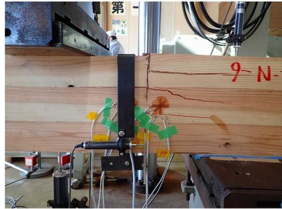
図III-28-(b)MNS-KN150-04 破壊性状
