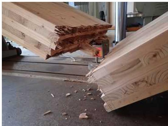
図VI. 1-(b) プライ縦継ぎ部の破壊 (PBNC-01)
