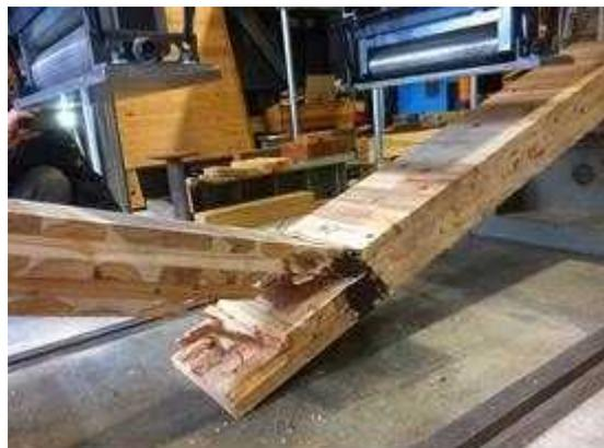
図 I. 4 3-(b) MGM-LJ150-01 破壊性状
