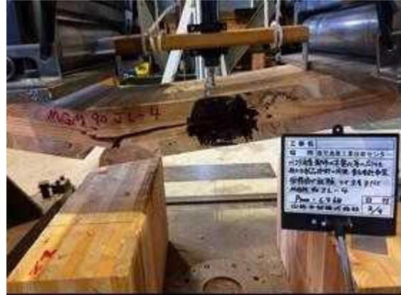
図 I. 2 2-(b) MGM-LJ90-04 破壊性状
