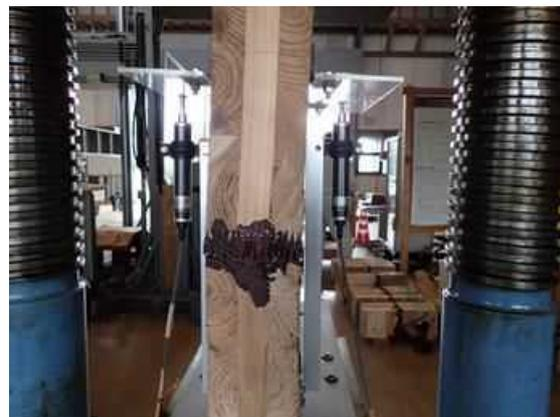
図IV. 9-(b) CNJ90-03 破壊性状
