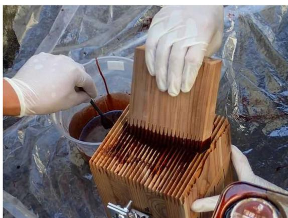
図2. 2. 3接着剤塗布の様子（フィンガー加工したラミナを楯として使用）
