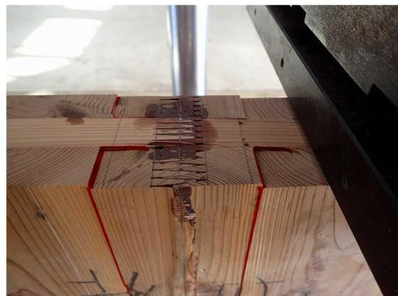
図III-12-(b)MNS-JN90-06 破壊性状
