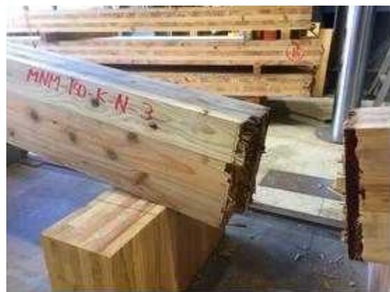
図 II. 27-(b) MNM-NK150-03 破壊性状
