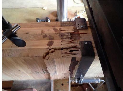
図III-43-(b)MNS-JL150-01 破壊性状
