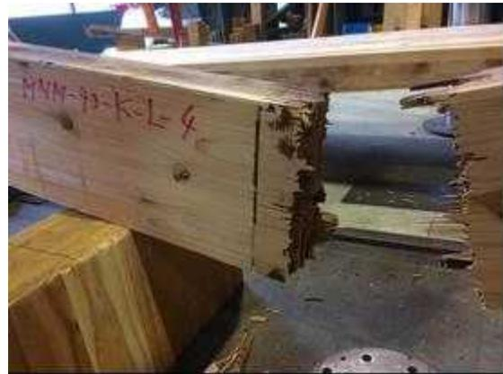
図 II. 1 6 -(b) MNM-LK90-04 破壊性状
