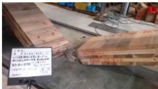
図 I. 3 3-(b) MGM-NJ150-03 破壊性状
