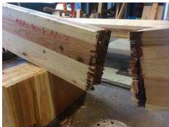
図 II. 3-(b) MNM-NK90-03 破壊性状
