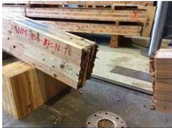
図 II. 1-(b) MNM-NK90-01 破壊性状
