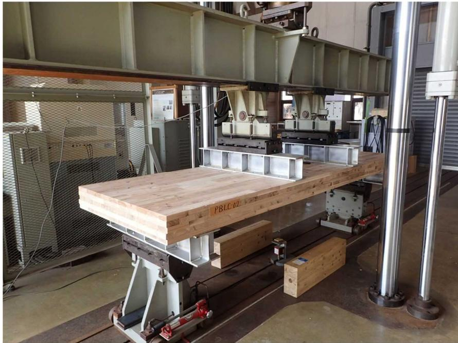
図6. 3. 1-(b) CLT パネルの面外曲げ試験 (FJ を中央に集中) の状況
