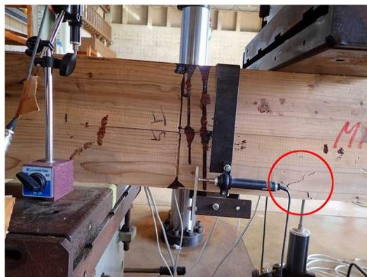
図III-2-(b)MNS-KN90-02 破壊性状
