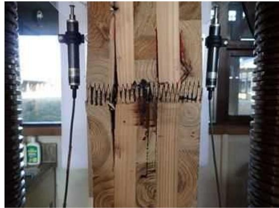
図IV. 3 5-(b) CNJ150-05 破壊性状
