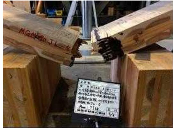
図 I. 2 3-(b) MGM-LJ90-05 破壊性状
