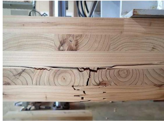
図6. 3. 14 最外層プライの縦継ぎフィンガー部より引張破壊 (PBLR-01)
