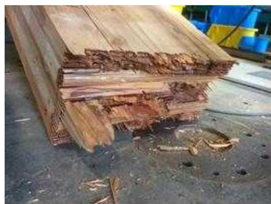
図 I. 30-(b) MGM-NK150-06 破壊性状
