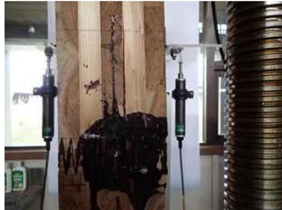
図IV. 4 6-(b) CLJ150-04 破壊性状
