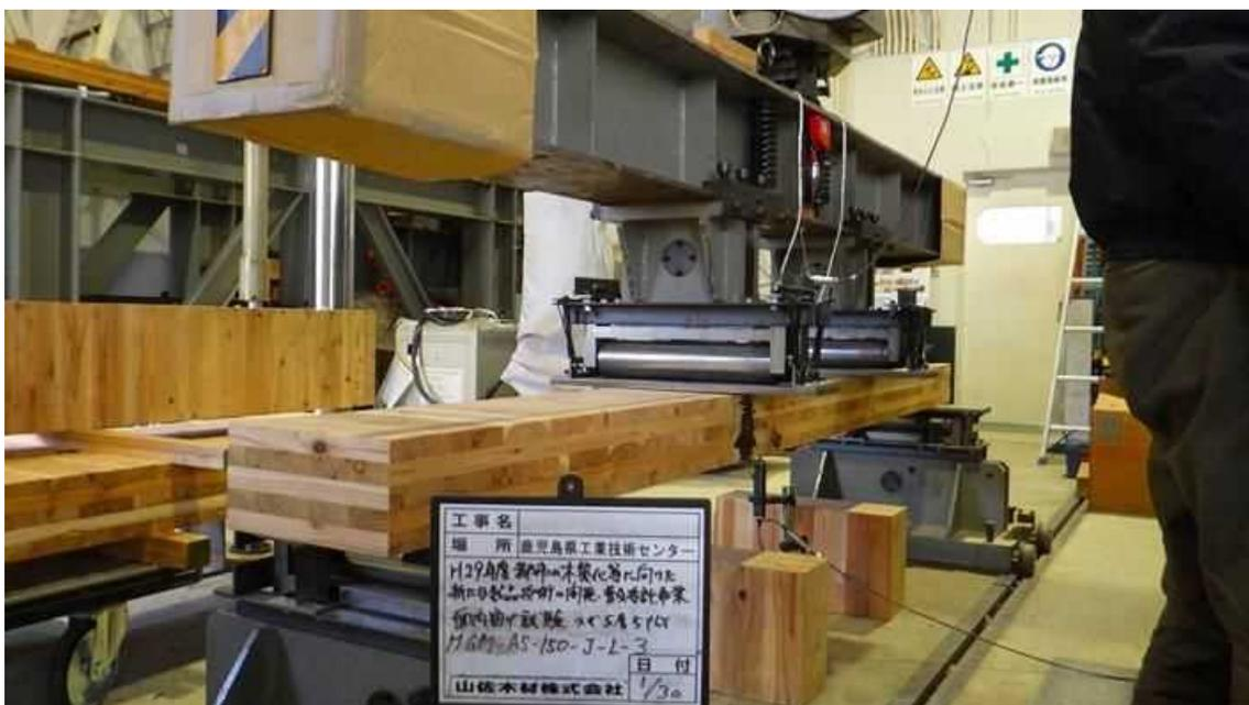
図3. 2. 3-(b) FJ接合したCLTパネルの面外曲げ試験 (FJを加力点直下に配した場合) (鹿児島県工業試験場)
