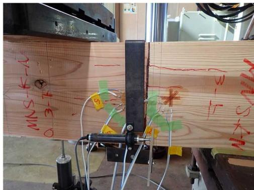
図III-1-(b)MNS-KN90-01 破壊性状
