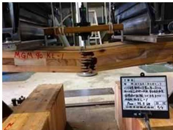
図 I. 1 3 -(b) MGM-LK90-01 破壊性状
