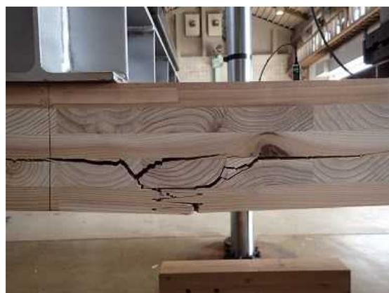
図VI. 1 3-(b) 最外層プライ縦継ぎフィンガー部での引張破壊 (PBLR-03)
