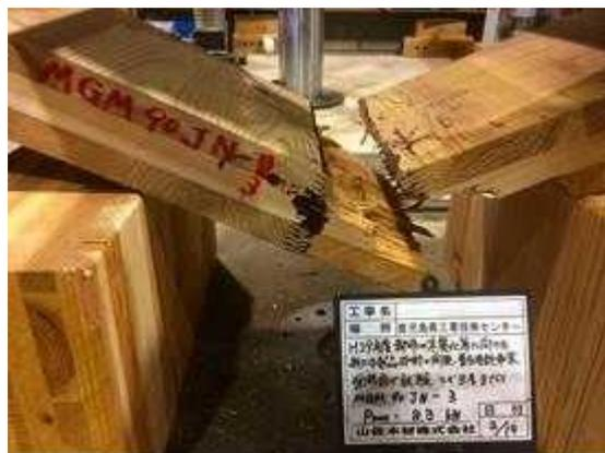
図 I. 9-(b) MGM-NJ90-03 破壊性状
