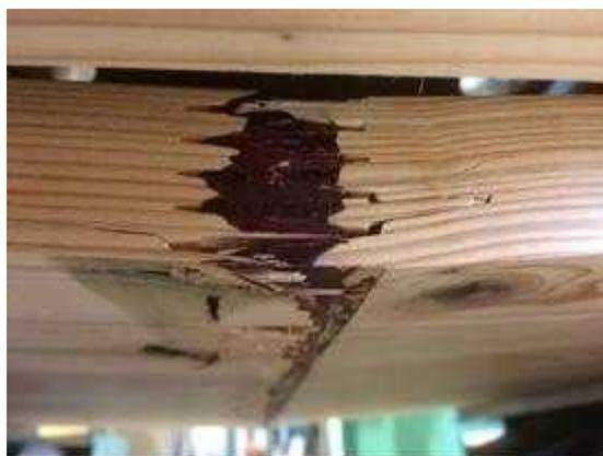
図 V. 19-(b) M60N-01 破壊性状
