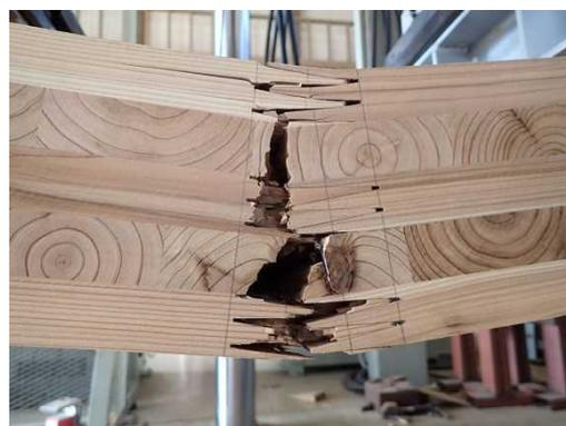
図6. 3. 12 プライ縦継ぎフィンガージョイントの引張破壊 (PBLC-02)
