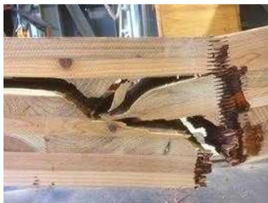
図 I. 50-(b) MGM-NK210-02 破壊性状
