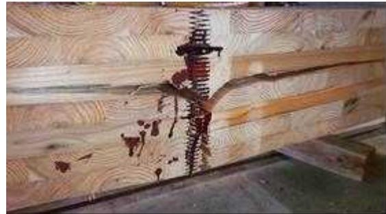
図 I. 56-(b) MGM-NJ210-02 破壊性状
