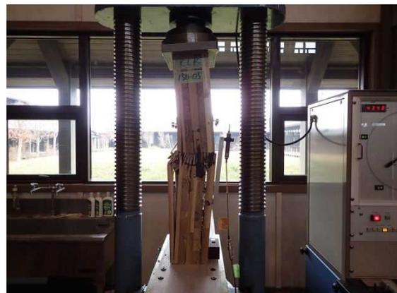
図 5. 5. 17 ラージフィンガー頂部からの CLT 割裂破壊 (CLK150)
