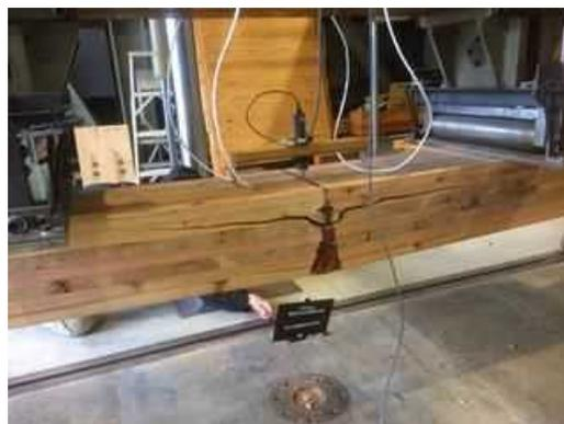
図 I. 49-(b) MGM-NK210-01 破壊性状
