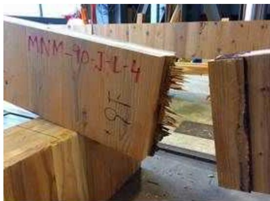
図 II. 2 2-(b) MNM-LJ90-04 破壊性状
