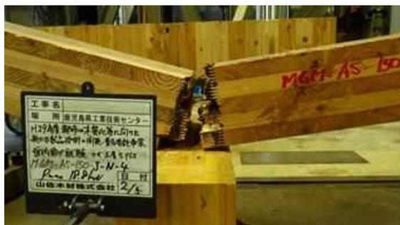
図 I. 8 3-(b) MGM-NJ150AS-05 破壊性状
