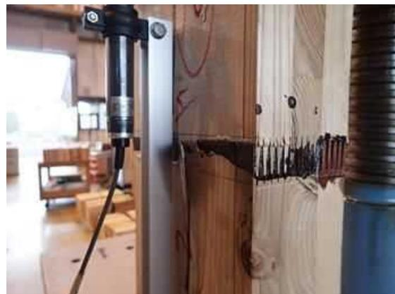
図IV. 3-(b) CNK90-03 破壊性状
