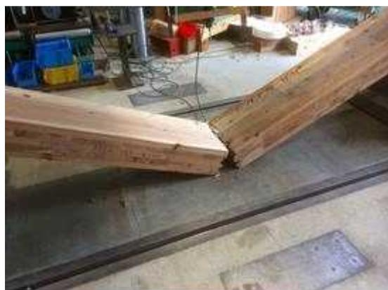
図 I. 2 6-(b) MGM-NK150-02 破壊性状
