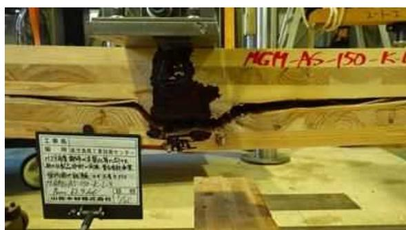
図 I. 6 9-(b) MGM-LK150AS-03 破壊性状
