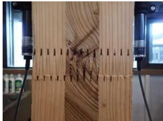
図IV. 5-(b) CNK90-05 破壊性状
