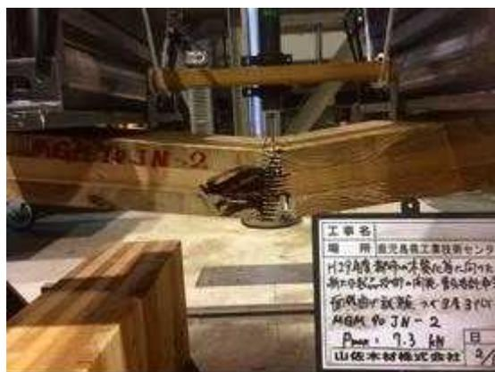
図 I. 8-(b) MGM-NJ90-02 破壊性状
