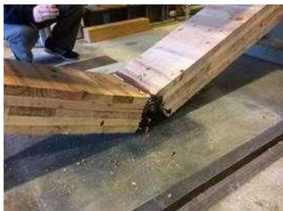
図 I. 4 4-(b) MGM-LJ150-02 破壊性状
