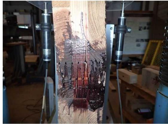
図 5. 5. 13 ラージフィンガー頂部から CLT 割裂破壊 (CLJ90)
