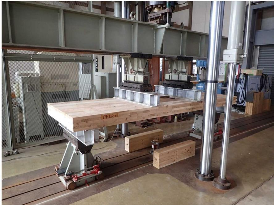
図6. 3. 2-(b) CLT パネルの面外曲げ試験（FJ を乱に配置）の状況
