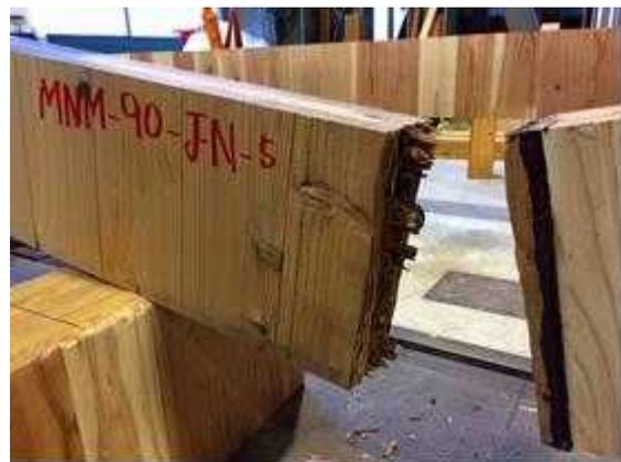
図 II. 11-(b) MNM-NJ90-05 破壊性状
