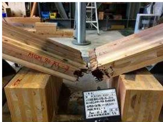
図 I. 1 5 -(b) MGM-LK90-03 破壊性状
