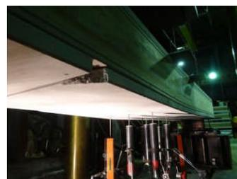
■ 破壊形式はCLTの曲げ破壊
