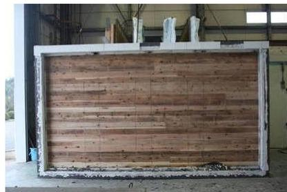
試験後の床下側：CLT表面の状況
