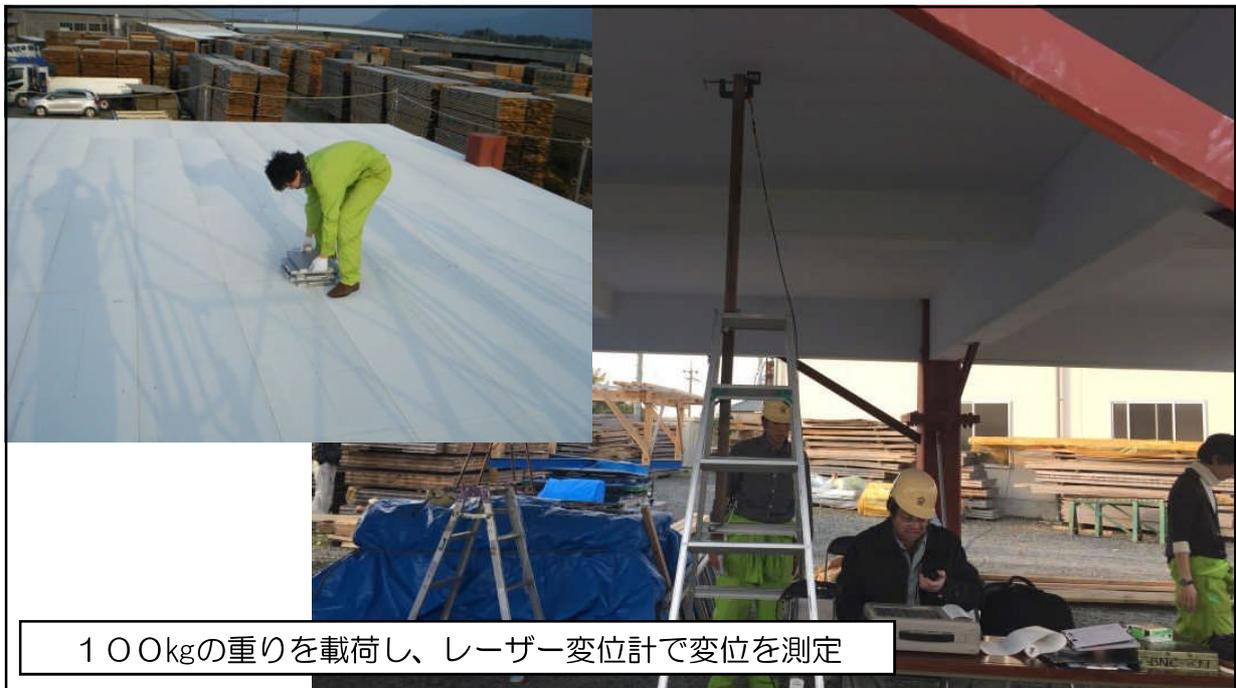
100kgの重りを載荷し、レーザー変位計で変位を測定
