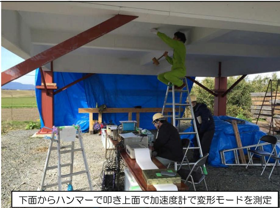
下面からハンマーで叩き上面で加速度計で変形モードを測定
