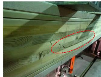
■ 破壊形式はCLTの曲げ破壊
