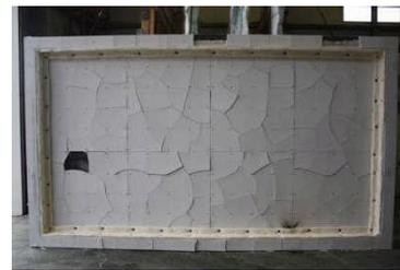
試験後の床下側：けい酸カルシウム板の状況
