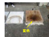
非加熱側CLTパネル(境界面 5)
