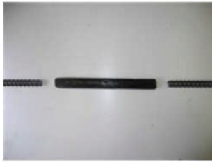
(a) 炭素繊維スリーブと接合鉄筋
