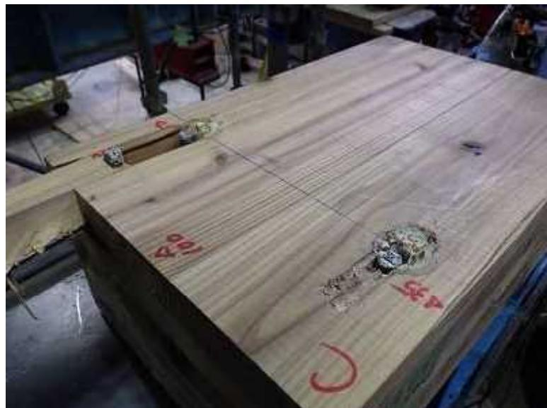
写真 6－1－2 スタッドの破断
