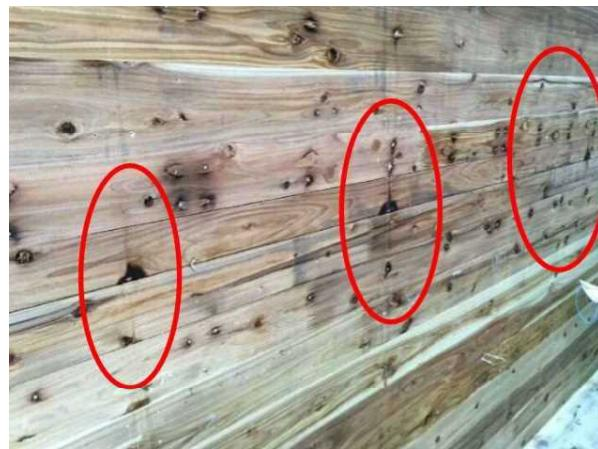
写真 3-2-2 試験結果 目地の焦げ
