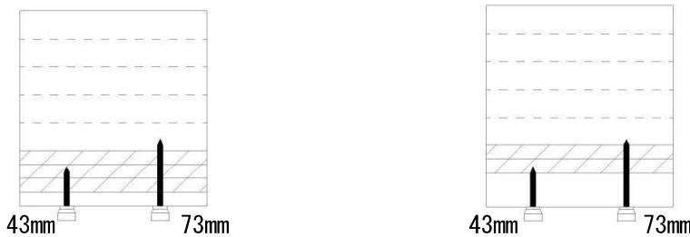
被覆材の合計厚さが60mmのため、73mmハンガーを用いると13mmCLTに埋め込まれる
