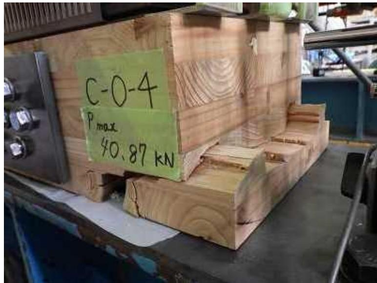
写真 6－9 端抜け破壊
