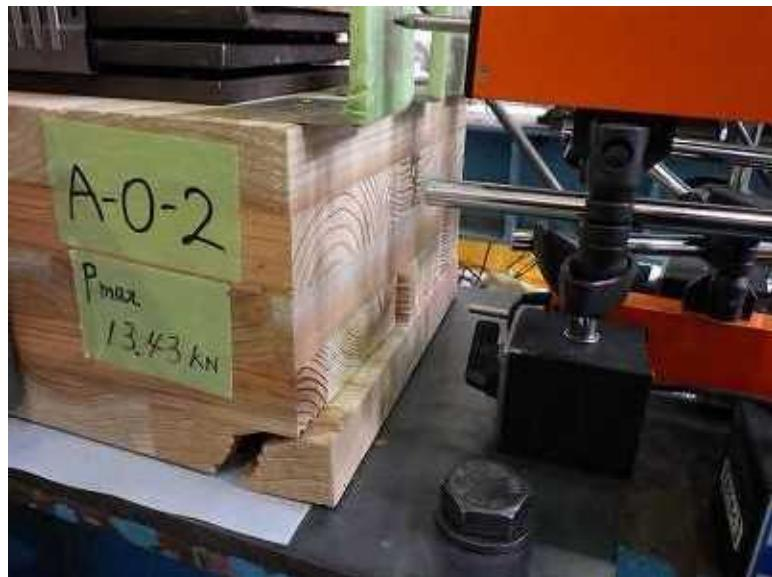
写真 6－2 端抜け破壊
