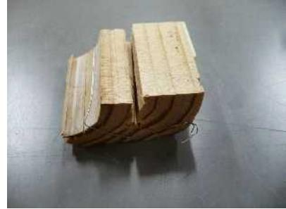
写真-2 試験後のベイマツ
