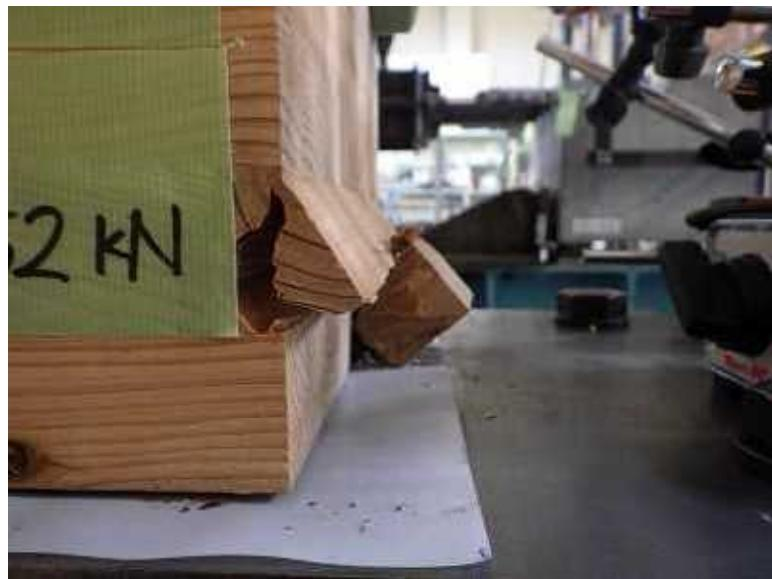
写真 6－4 端抜け破壊
