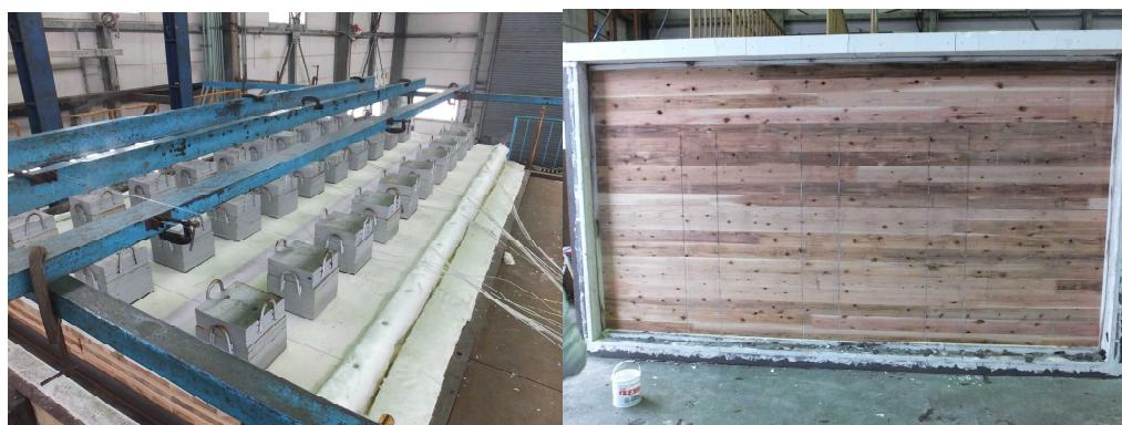
写真 3-4-3-2 性能評価 下面試験体設置状況と合格結果
