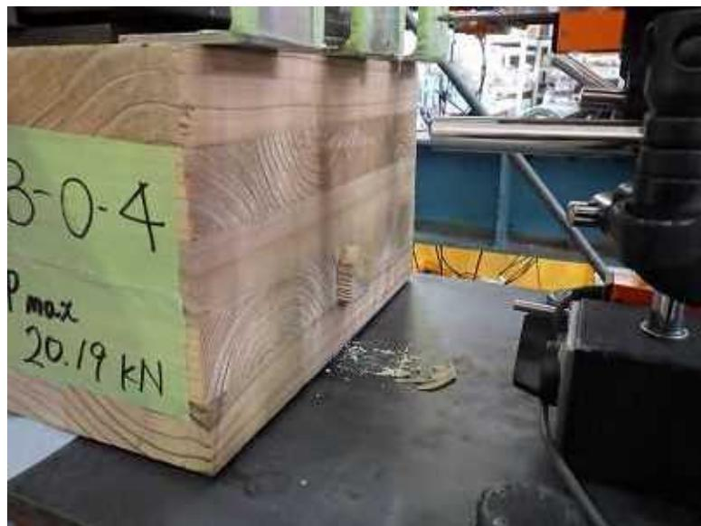
写真 6－5 端抜け破壊
