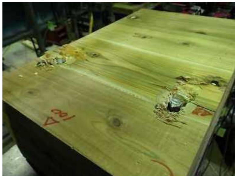
写真 6－10 スタッドの破断
