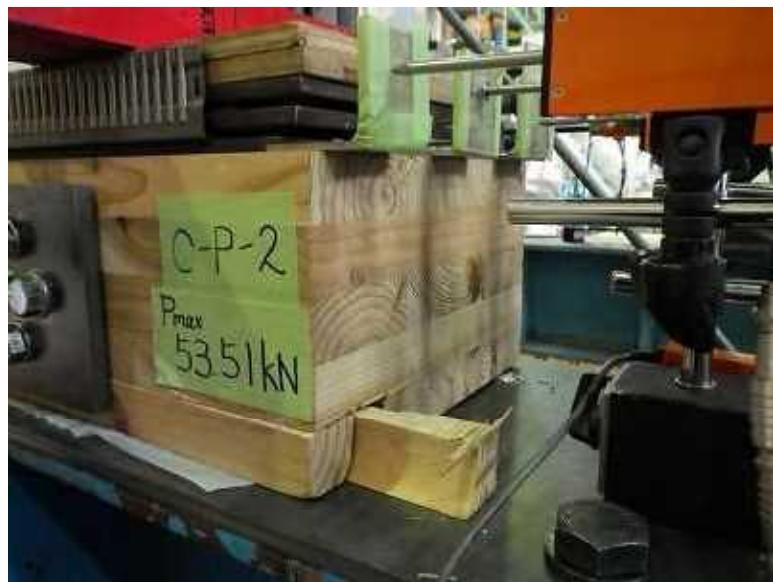
写真 6－1－1 端抜け破壊
