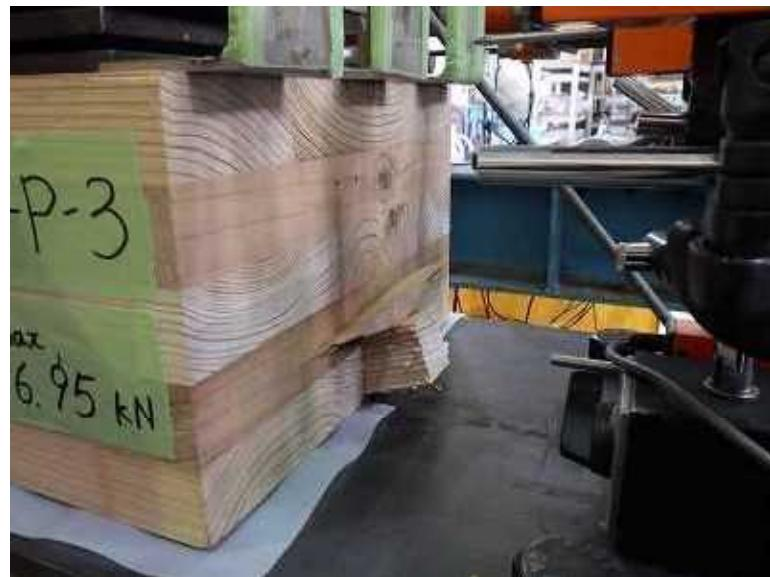
写真 6－8 端抜け破壊
