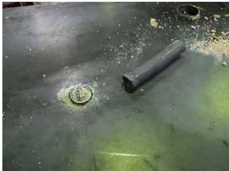
写真 6－6 スタッドの破断
