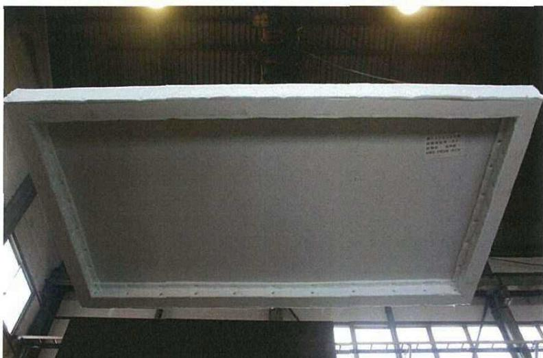
写真－11 試験前の加熱側（天井側）
