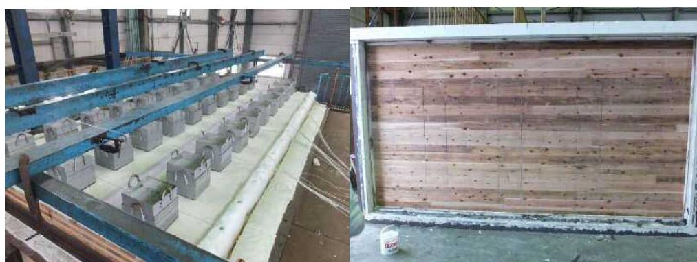
写真 3-4-3-2 性能評価 下面試験体設置状況と合格結果
