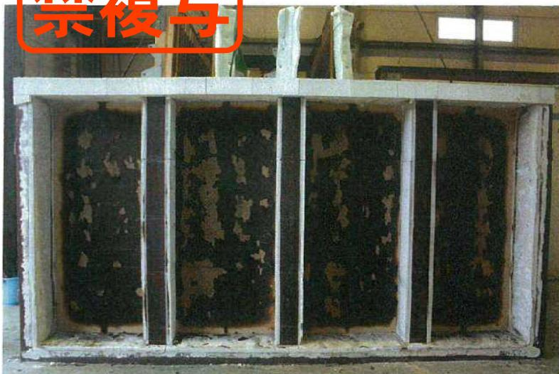
写真－7 試験後の加熱側
