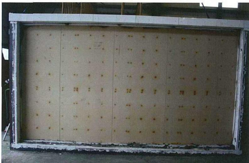
写真－8 試験後の加熱側（天井側）
