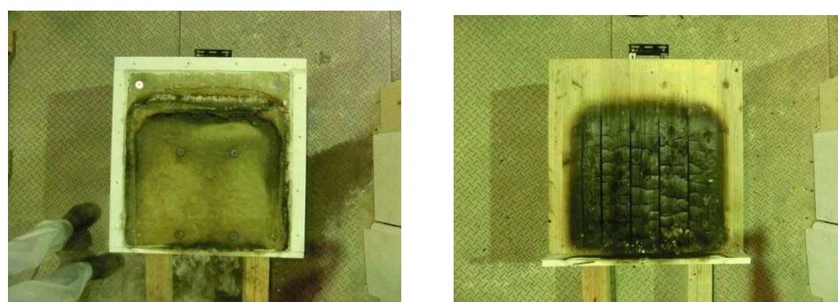
図12 加熱後の試験体
