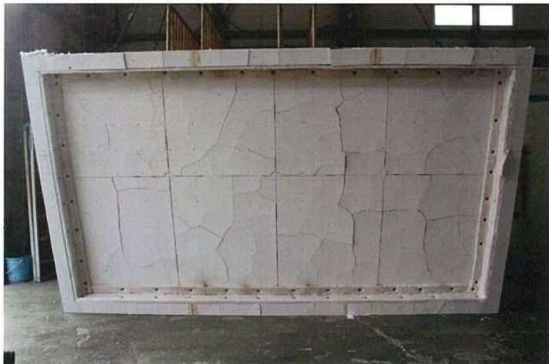
写真－5 試験後の加熱側（天井側）
