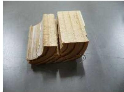
写真-2 試験後のベイマツ
