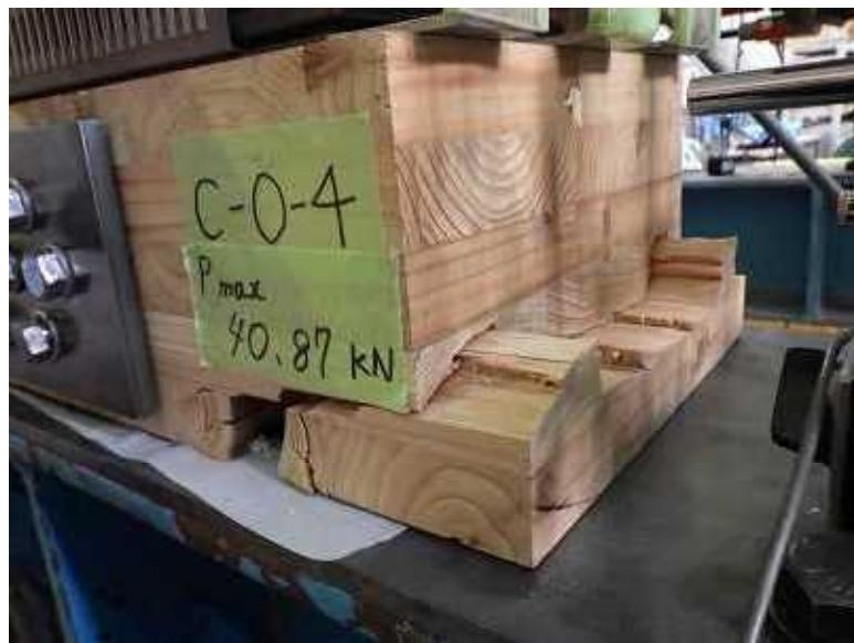
写真 6－9 端抜け破壊
