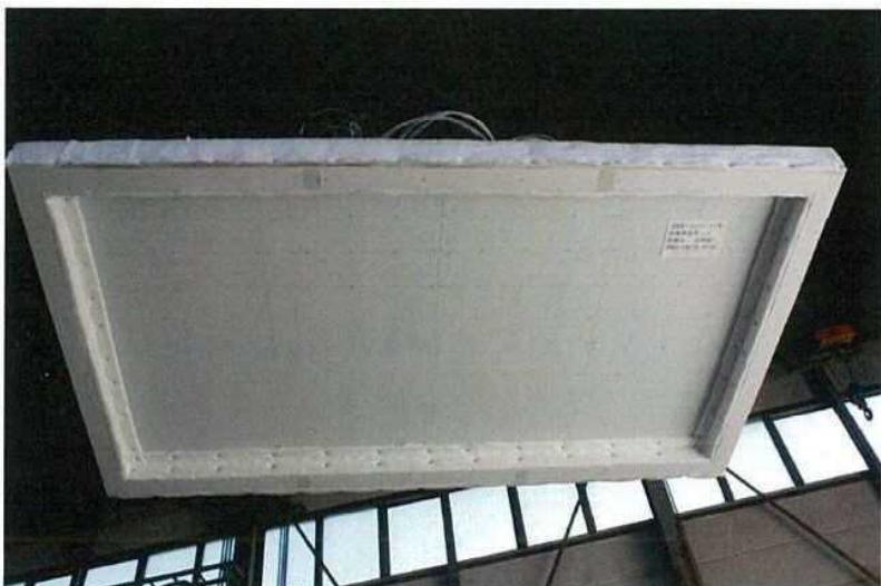
写真－2 試験前の加熱側（天井側）
