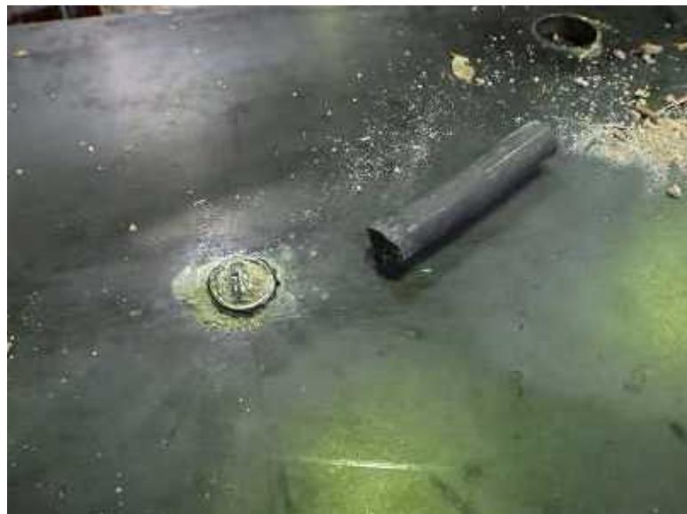
写真 6－6 スタッドの破断
