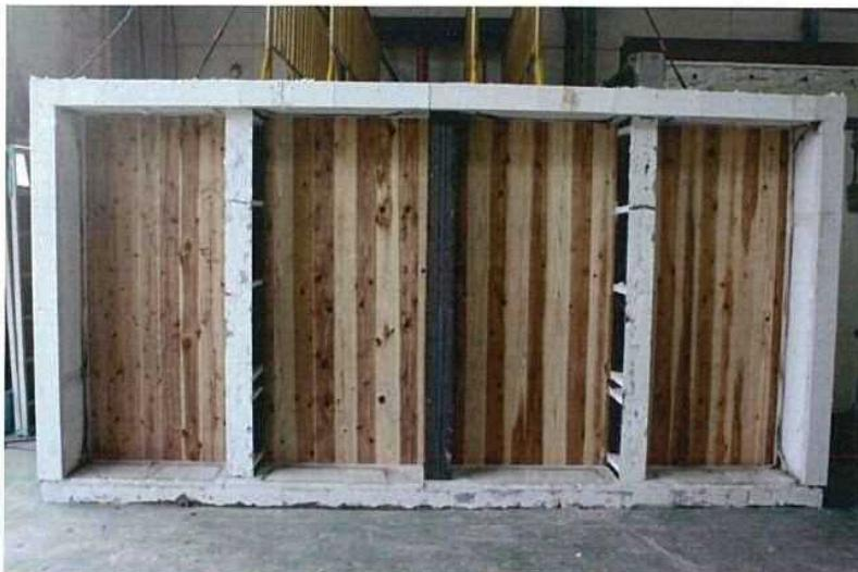
写真-7 試験後の加熱側
