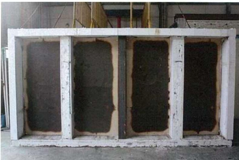
写真-5 試験後の加熱側
