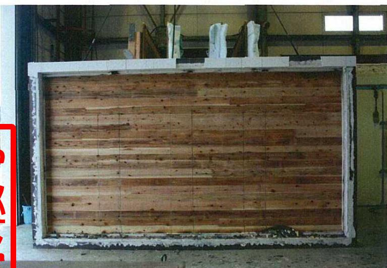
写真－18 試験後の加熱側（天井側）
