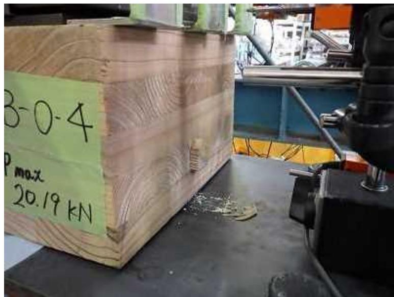
写真 6－5 端抜け破壊
