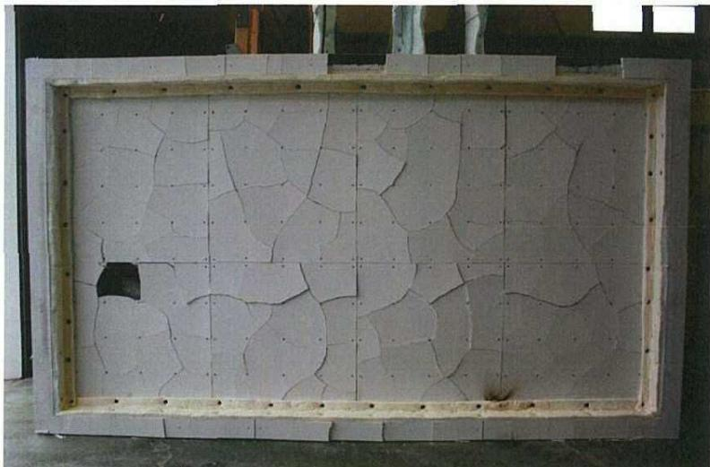
写真－14 試験後の加熱側（天井側）
