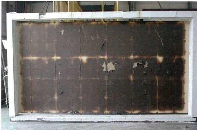
写真－7 試験後の加熱側（天井側）
