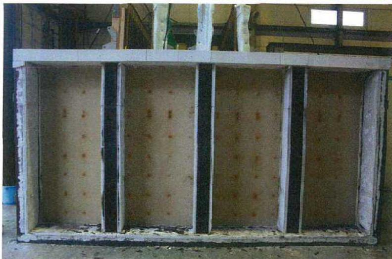
写真－8 試験後の加熱側
