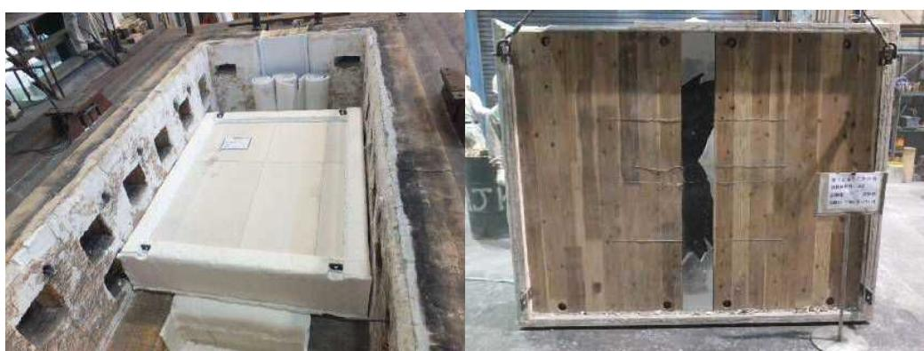
写真 3-4-3-1 性能評価 上面試験体設置状況と合格結果
