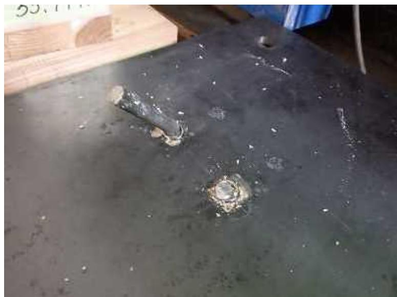
写真 6－14 スタッドの破断及び変形
