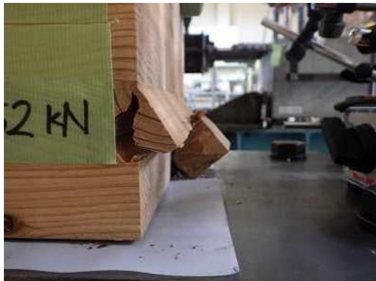
写真 6－4 端抜け破壊
