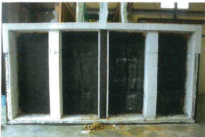
写真－6 試験後の加熱側
