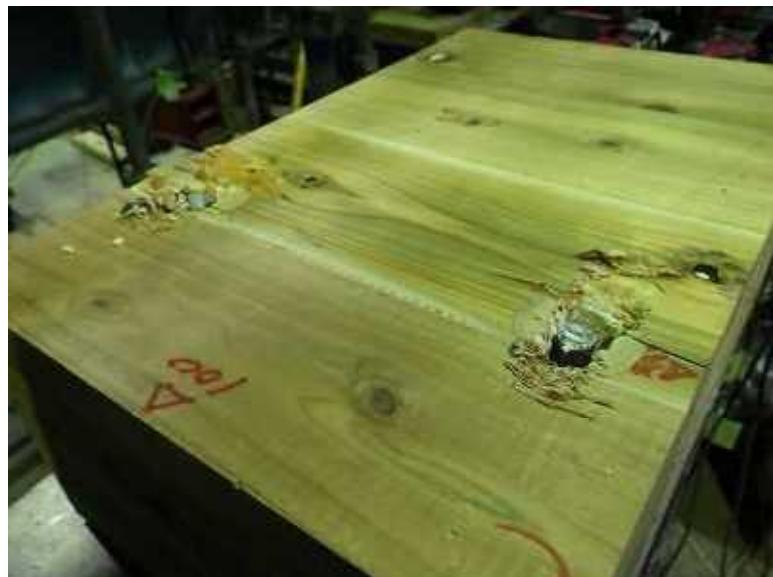
写真 6－10 スタッドの破断
