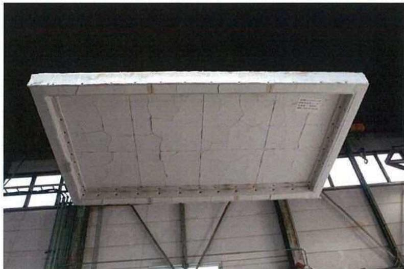
写真－4 試験後の加熱側（天井側）
