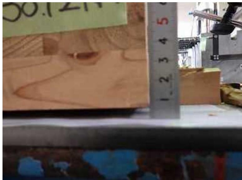
写真 6－16 CLT の浮き上がり
