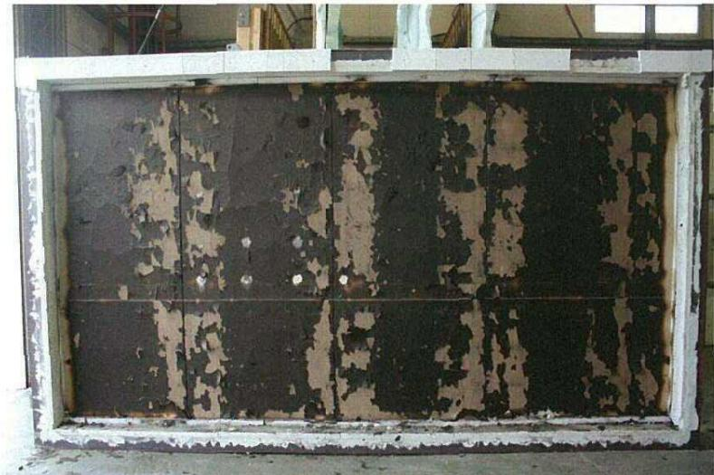
写真－16 試験後の加熱側（天井側）
