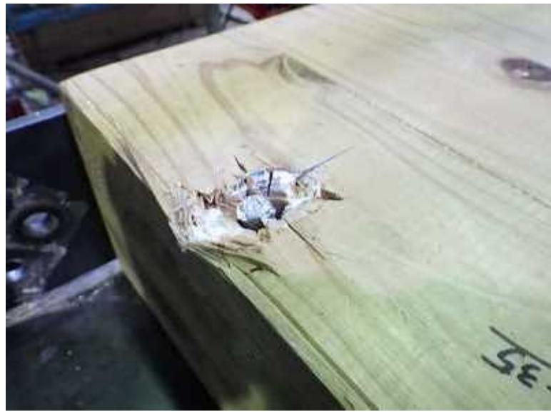
写真 6-17 スタッドの破断
