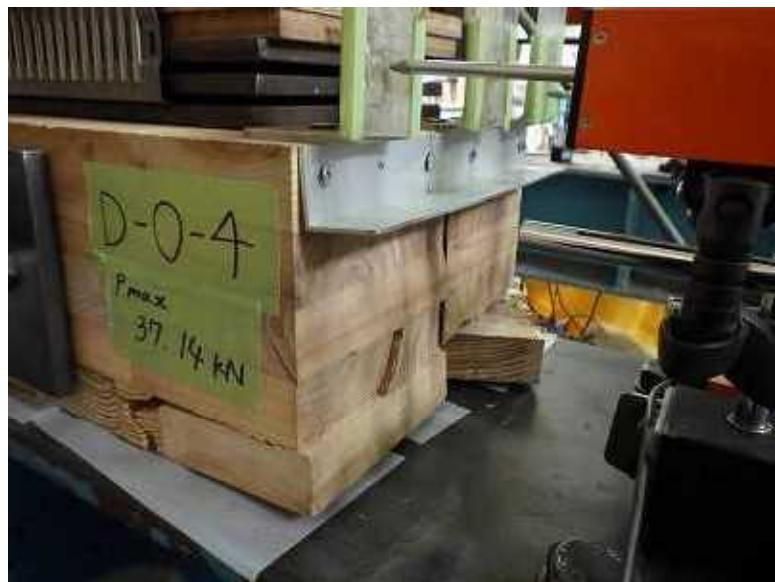
写真 6－13 端抜け破壊
