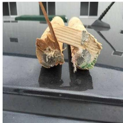
写真・4 燃焼試験後の注入部分
