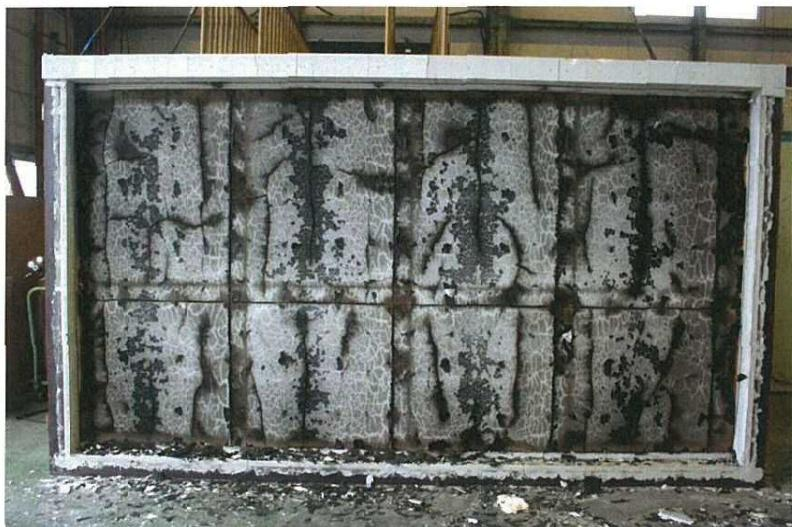
写真－6 試験後の加熱側（天井側）
