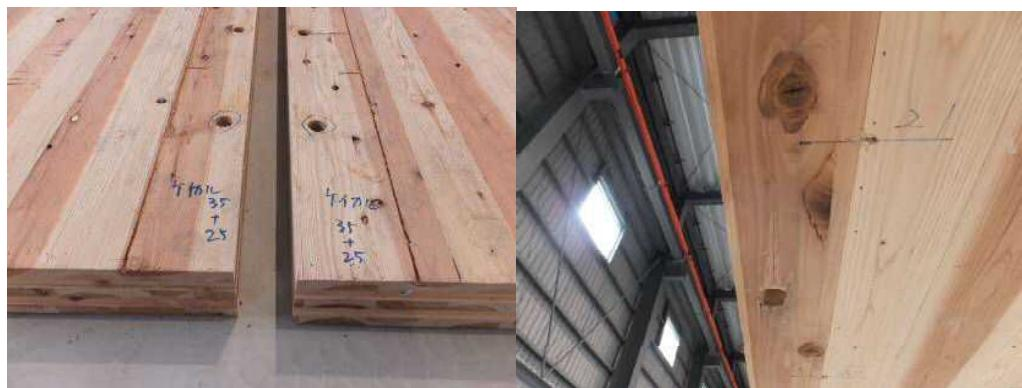
写真 3-3-3B-7 解体後の CLT 表面 けい酸カルシウム板 35mm+25mm
