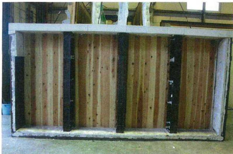
写真－9 試験後の加熱側
