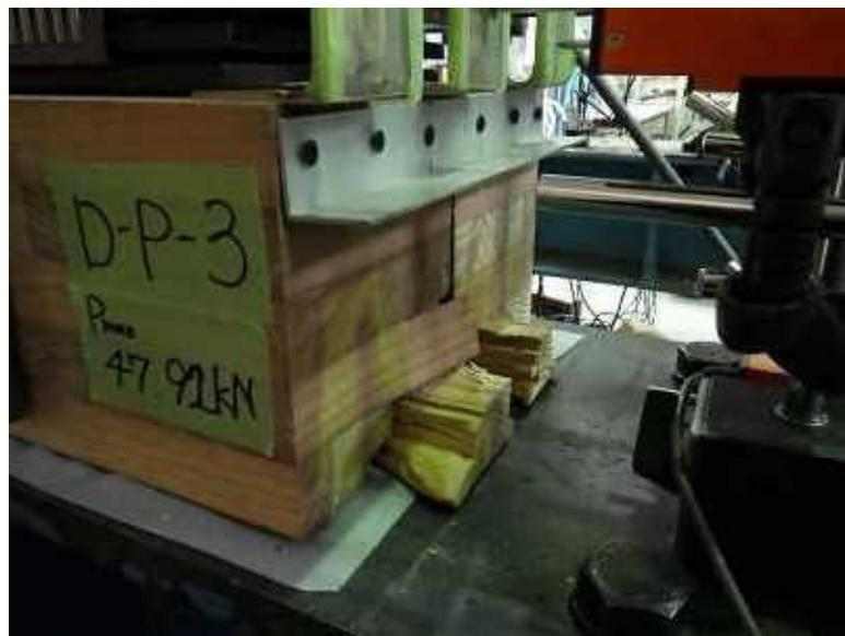
写真 6－15 端抜け破壊
