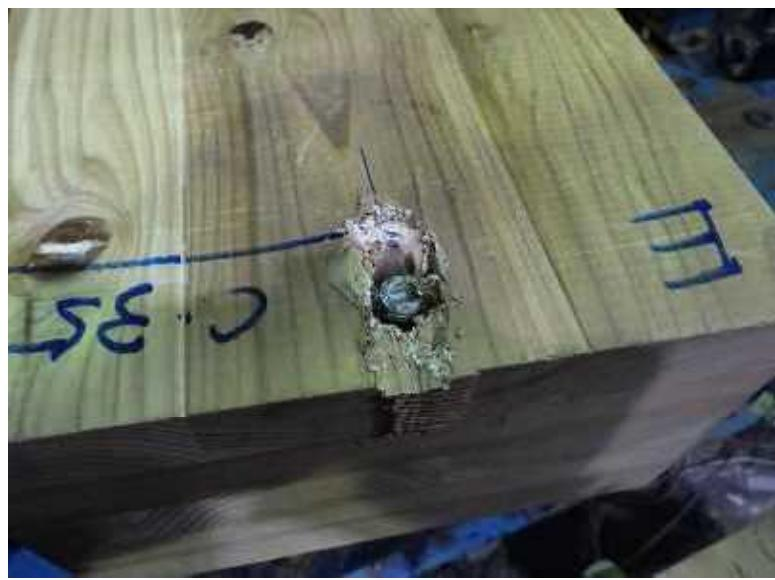
写真6－19 スタッドの破断
