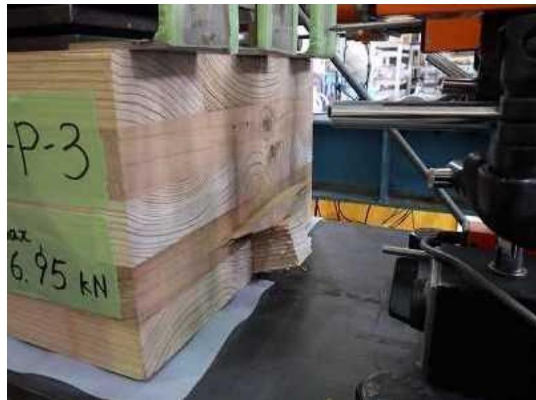
写真 6－8 端抜け破壊
