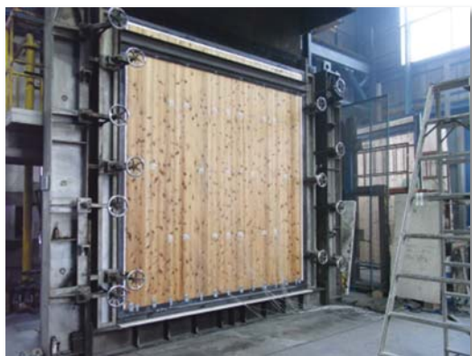
性能評価試験の様相 ※ 60分耐火性能
