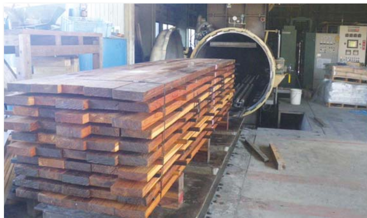
集成材を構成するラミナへのDOT加圧注入状況
