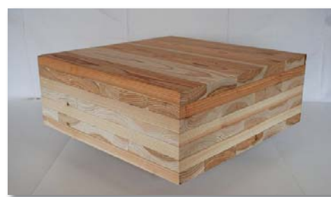
国産スギCLTの試作サンプル
